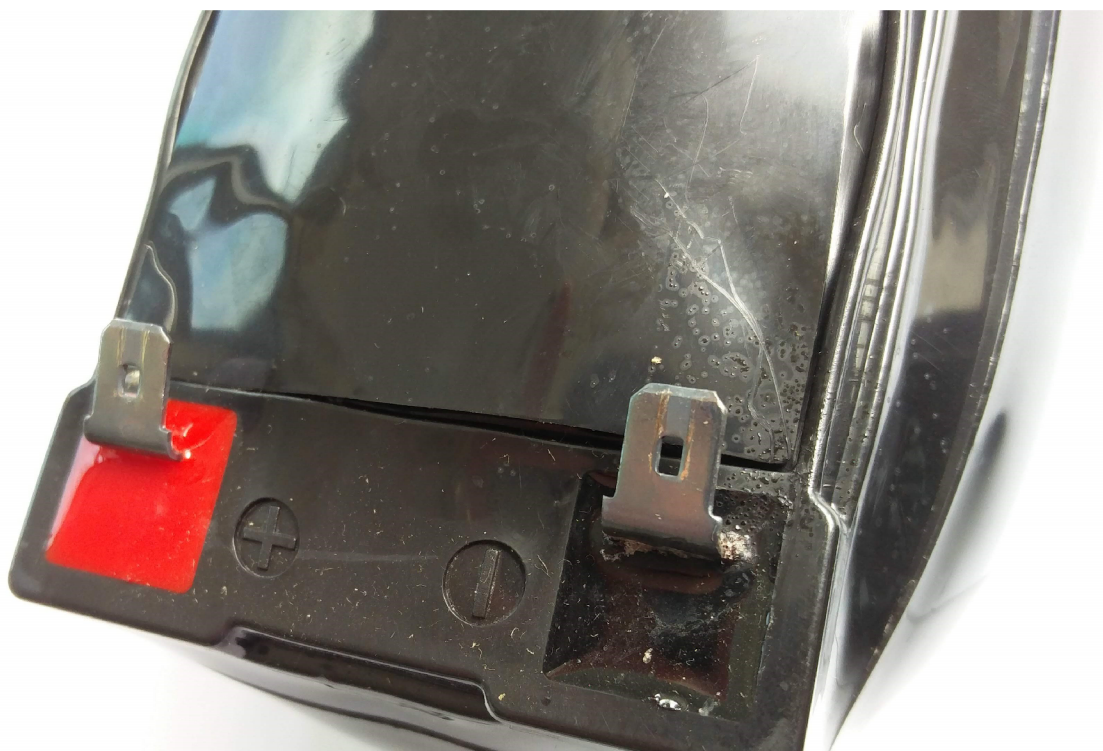
Obr. 2.20: Vyžhání vývodového pólu vysokou teplotou, nadměrný tlak v rámci akumulátoru zapříčinil únik elektrolytu mimo nádobu akumulátoru.
