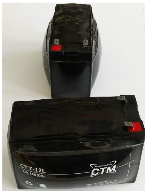
Obr. 2.19: Nádoba akumulátoru č.2 zdeformovaná extrémně vysokou teplotou.
