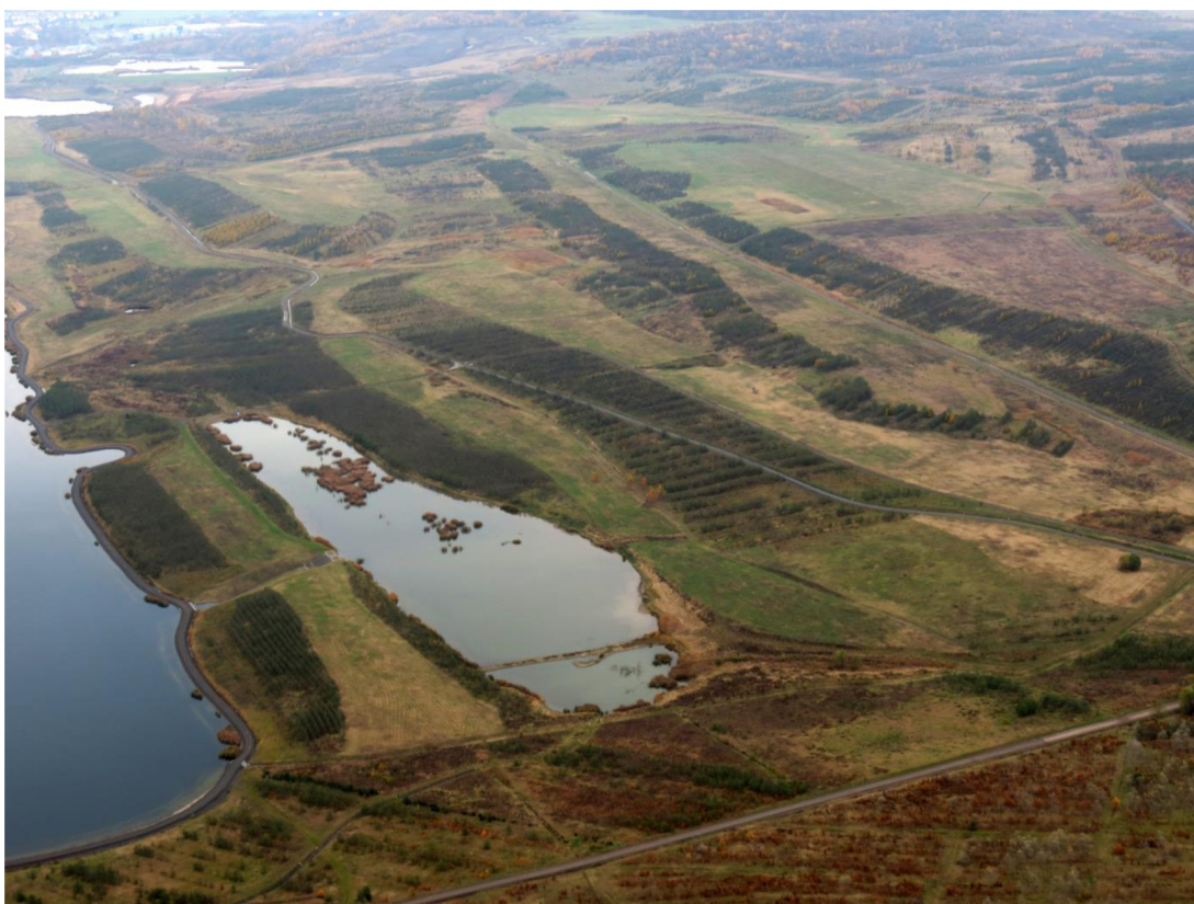
Obrázek 5: Vnitřní výsypka lomu Chabařovice - západní část s protieutrofizační nádrží (Palivový kombinát Ústí).
