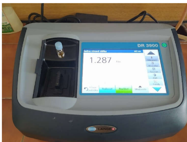
Obr. 4.4 Měření absorbance v přístroji Hach DR 3900 [foto vlastní]
