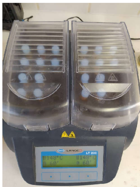
Obr. 4.3 Mineralizace v přístroji Hach LT 200 [foto vlastní]
