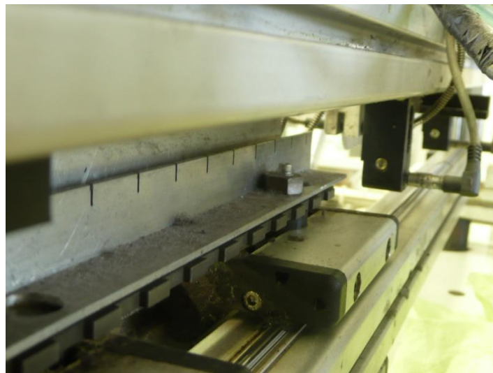
Obr. 10. Rozeta (hliníková lišta, ve které jsou vyfrézovány přesné drážky)
