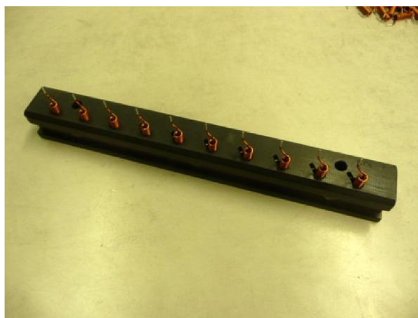
Obr. 2. Cívka umístěná ve speciální liště
