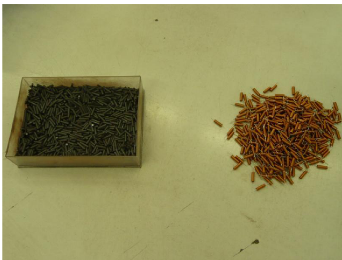
Obr. 6. Feritová jádra a měděné cívky
