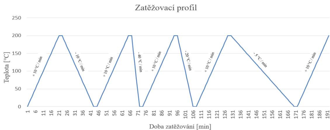
Obr. 23 Průběh zatěžovacího teplotního profilu vzorku během DSC analýzy
