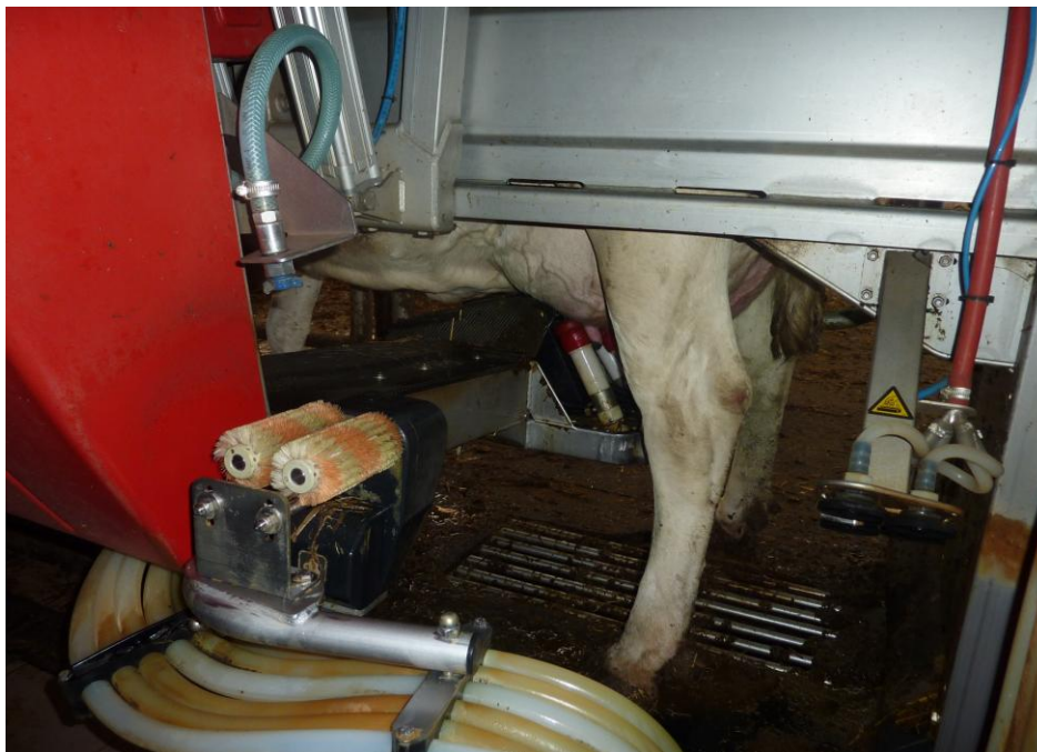
Obrázek 3: Pohled na kartáče a dojící násadce dojícího robota
