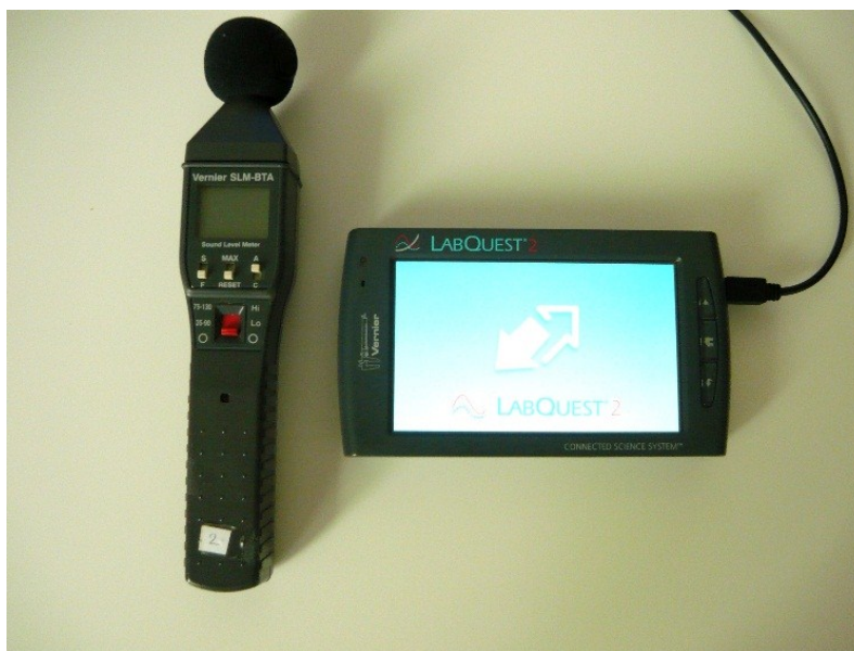
Obr. 15 – Hlukoměr Vernier SLM-BTA a Datalogger LabQuest
