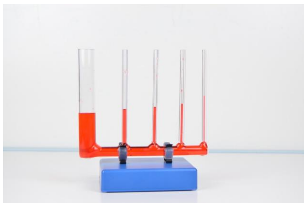
Obrázek 5: Sada trubic na demonstraci kapilarity. Zdroj: https://fyzikálníkabinet.cz/pokus/kapilarita/
