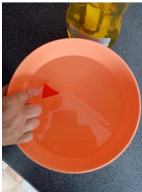
Obrázek 10: Saponátem měníme povrchové napětí. Zdroj: vlastní experiment
