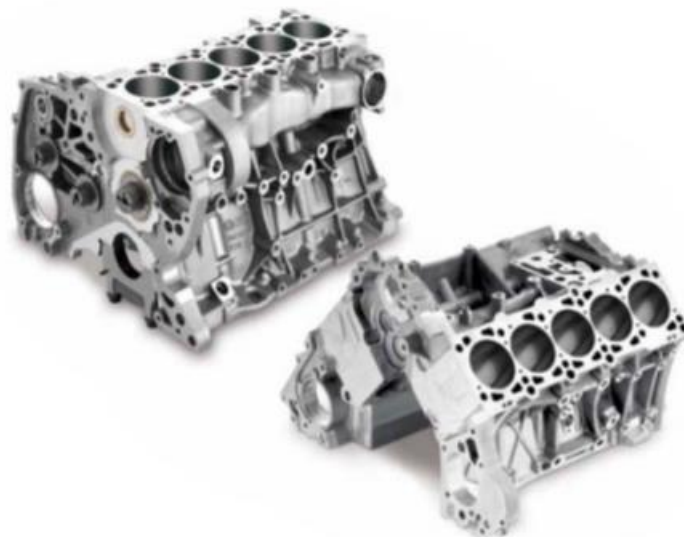
Obr. 3: Bloky motorů VW vyrobených ze slitiny ALUSIL® [27]
