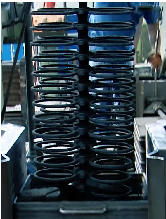
Obr. 10: Stromečkové uspořádání odlitku pístních kroužků při vytahování z pískové formy
