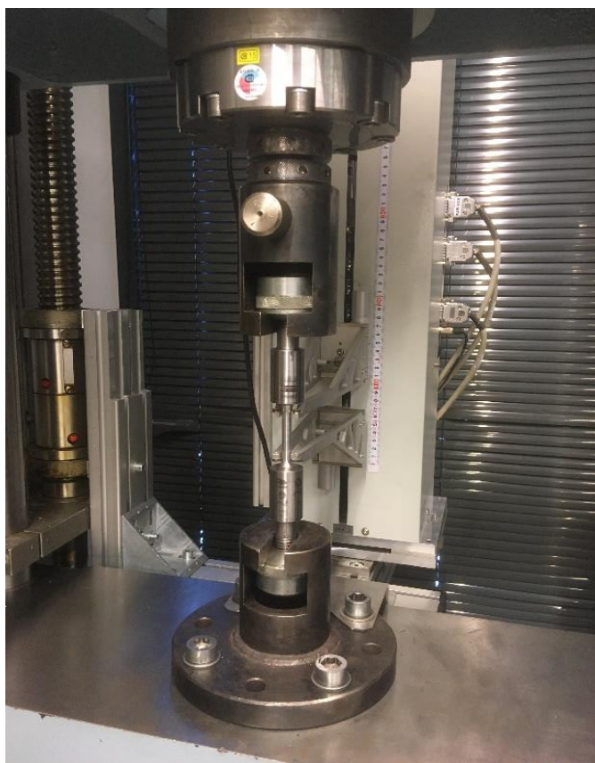
Obr. 3.9 Statická zkouška tahem na přístroji TIRA test 2300
