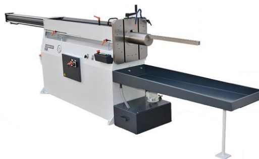
Obr. 2.7 Vodorovná protahovačka HRY 1450/6 [18].
