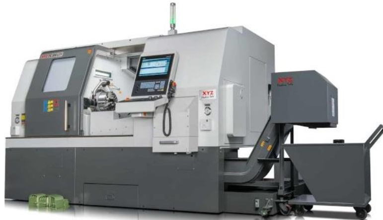
Obr. 2.12 Soustružnické 4-osé centrum XYZ 320 LTY [15].
