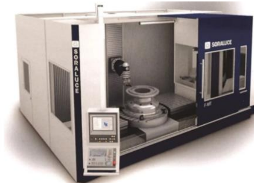
Obr. 2.13 Multifunkční stroj F-MT s pohyblivým stojanem (Soralluce) [25].
