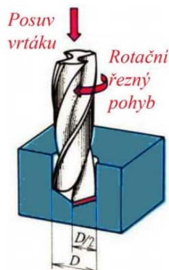
Obr. 1.5 Schéma vrtání ( D – průměr vrtáku) [10].
