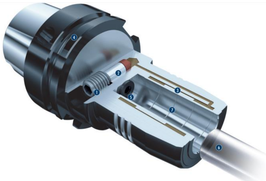
Obr. 3.15 Průřezový diagram upínače Tendo E compact (1 – aktivační šroub, 2 – upínací píst, 3 – rozpínací pouzdro a olejová komora, 4 – základní těleso, 5 – šroub pro nastavení délky upnutí, 6 – nástroj, 7 – drážka pro odvedení nečistot) [35].
