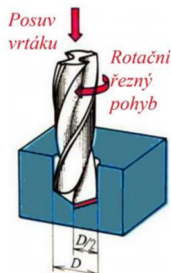
Obr. 1.5 Schéma vrtání ( D – průměr vrtáku) [10].
