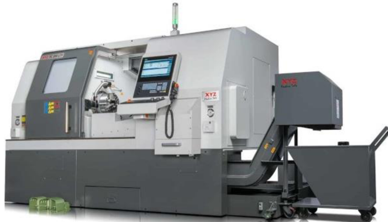
Obr. 2.12 Soustružnické 4-osé centrum XYZ 320 LTY [15].
