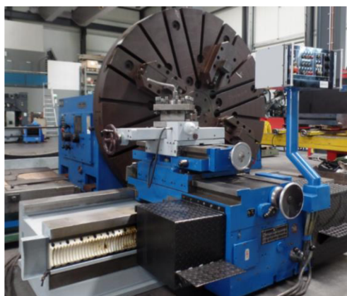
Obr. 2.1 Dvoustojanový svislý soustruh (vlevo) [6], Čelní soustruh WMW – Madgeburg (vpravo) [50].
