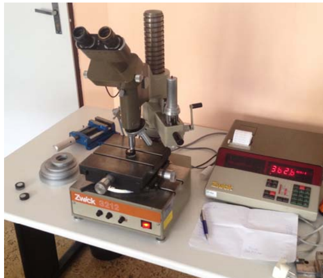
Obr. 31: Mikrotvrdoměr ZWICK 3212 na TU v Liberci
