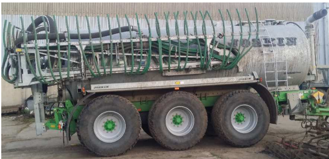
Obrázek 1: Joskin 22/45 s 18m širokým hadicovým aplikátorem (Foto: Pásek)
