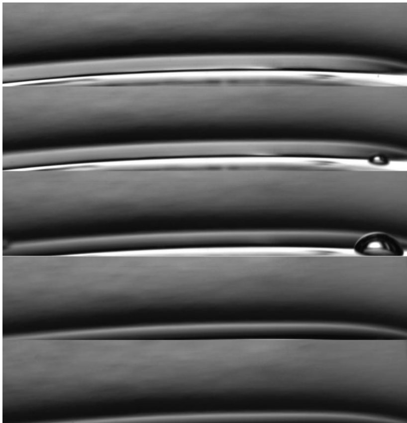
Obr. 4.8 Na záberoch z vysokorýchlostnej kamery je zachytený rast kavitačnej bubliny, ale kvôli pohybu fľašky ku kolapsu bubliny došlo mimo záber. Medzi jednotlivými snímkami je konštantný časový rozdiel 0,5 ms.
