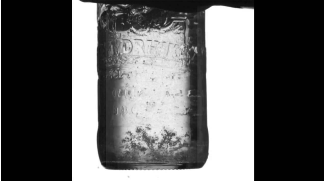
Obr. 3.1 Kavitačné bubliny vzniknuté v sklenenej nádobe po náraze[17]
