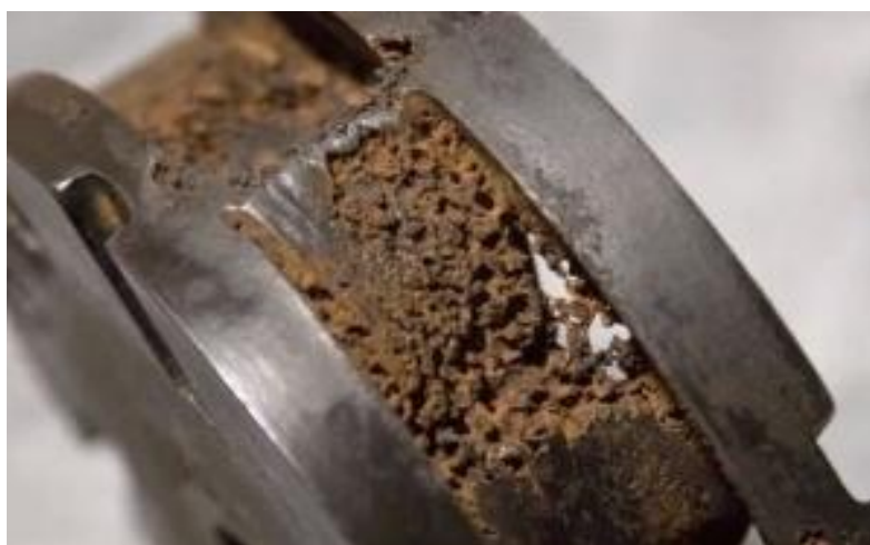
Obr. 2.7 Poškodenie spôsobené kavitáciou na obežnom kolese vodnej pumpy[11]
