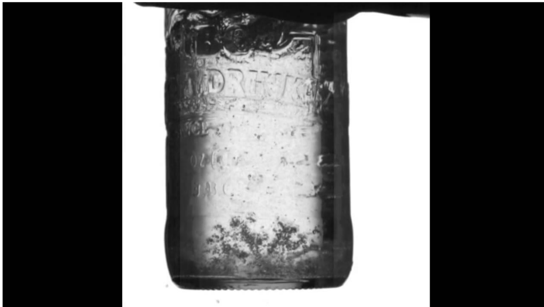
Obr. 3.1 Kavitačné bubliny vzniknuté v sklenenej nádobe po náraze[17]
