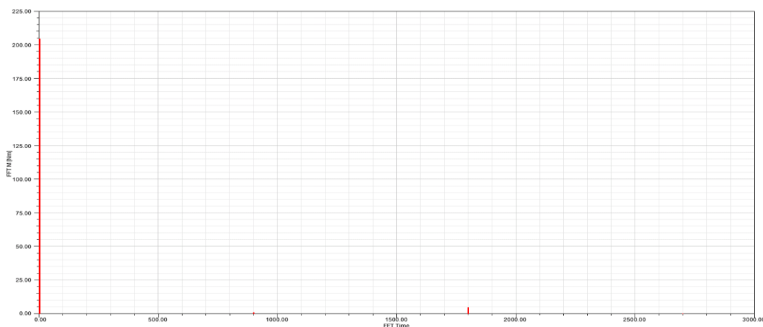
Obr.4- 18 Harmonické složky momentu šestipólového motoru
