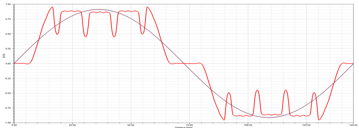
Obr. 4- 5 Průběh indukce v mezeře šestipólového motoru
