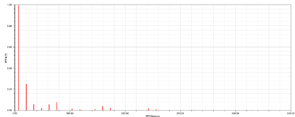
Obr.6-1 Harmonické složky průběhu indukce v mezeře motoru s magnety na povrchu
