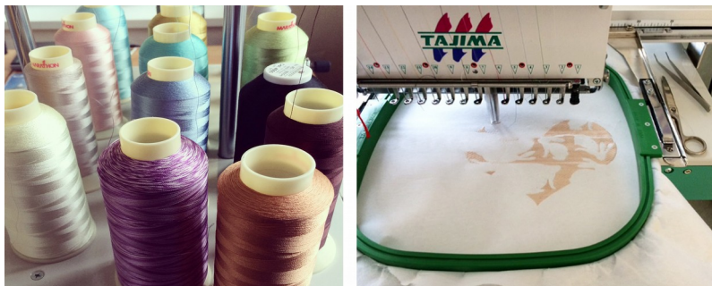
Obrázek 28 Použité vyšívací polyesterové nitě a stroj Tajima při vyšívání zkušebního motivu.
