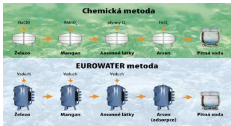
Obrázek 8: Schéma chemické a fyzikální úpravy podzemní vody při výrobě pitné vody
