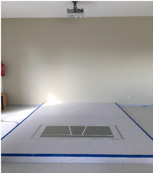
Obrázek 10. Tenzometrická plošina a elektrické měřicí zařízení značky AMTI (vlastní zdroj)
