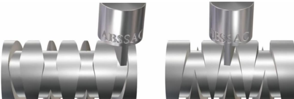
Obr. 10 Vedení jazýčku závity samovratného šroubu [36]
