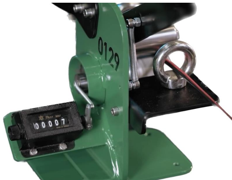
Obr. 13 Měření kabelu pomocí pružiny na mechanické počítadlo [40]
