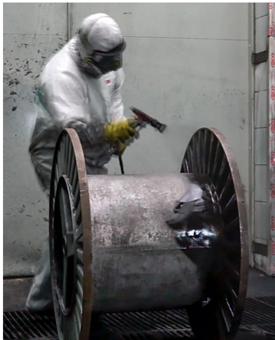
Obr. 12 Nástřik ochranné barvy na kovový buben [39]
