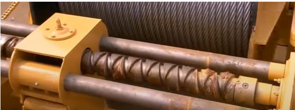
Obr. 33 Mazání samovratného šroubu mazací pastou [42]
