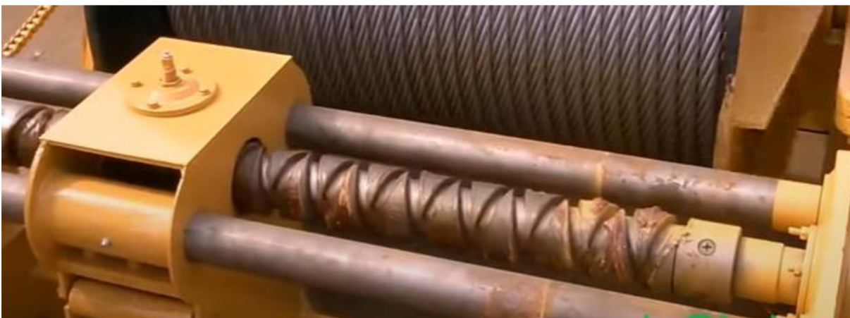
Obr. 33 Mazání samovratného šroubu mazací pastou [42]
