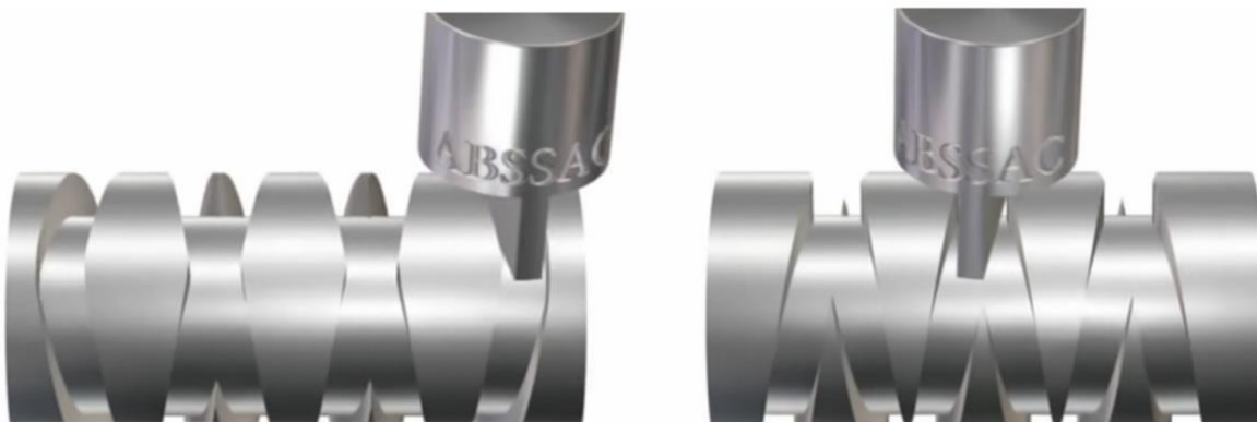
Obr. 10 Vedení jazýčku závity samovratného šroubu [36]
