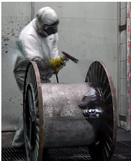
Obr. 12 Nástřik ochranné barvy na kovový buben [39]
