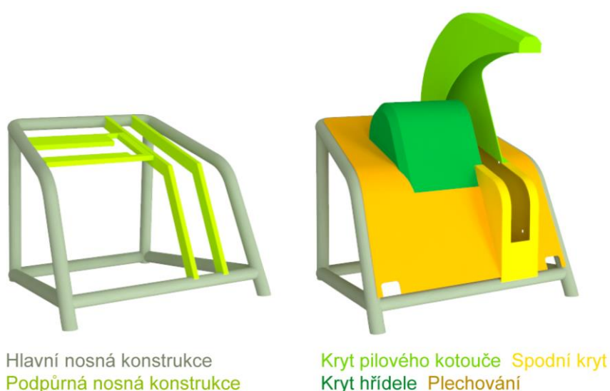
obr. 6-5 Schéma nosné konstrukce a krytování
