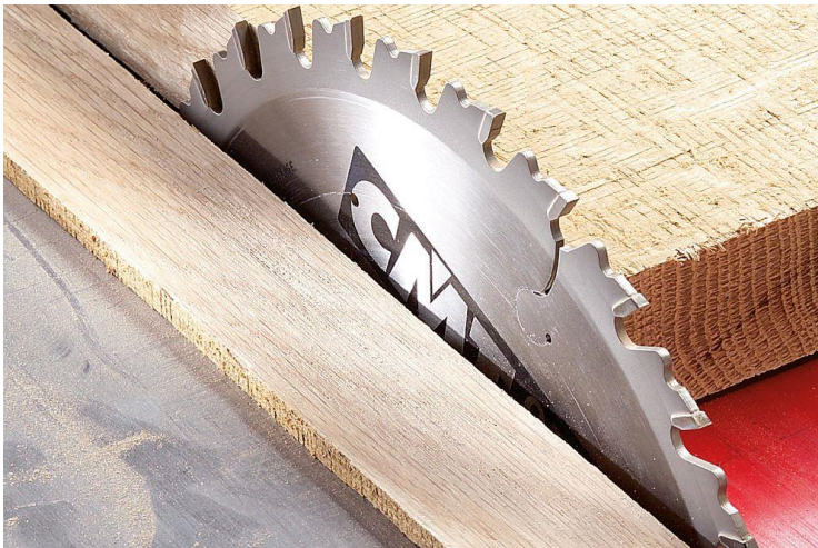
obr. 2-21 Vidiový pilový kotouč s destičkami ze slinutého karbidu [22]
