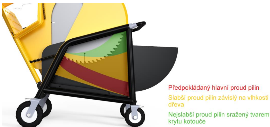
obr. 6-10 Předpokládané proudy pilin
