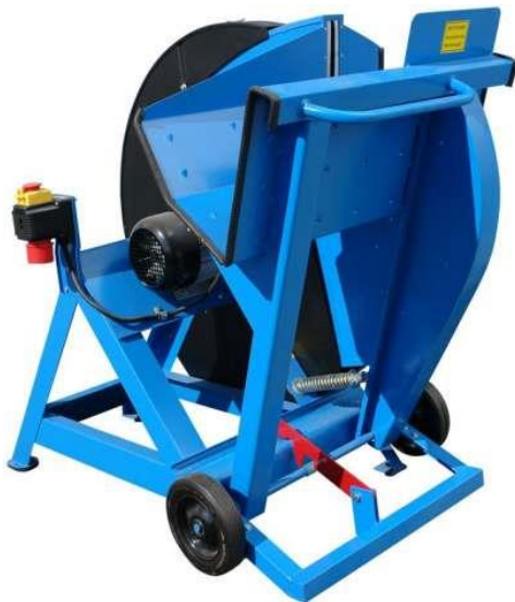
obr. 2-18 Konstrukce kolébkové pily [19]
