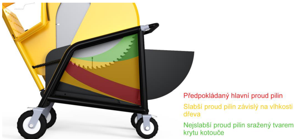
obr. 6-10 Předpokládané proudy pilin
