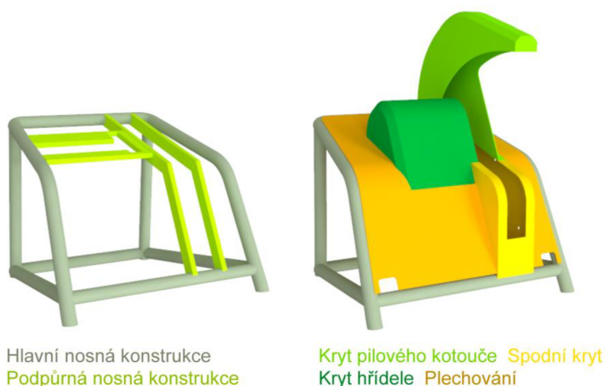
obr. 6-5 Schéma nosné konstrukce a krytování
