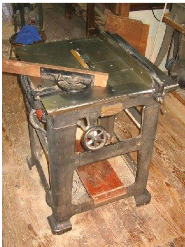
obr. 2-3 První kotoučová pila s přímým pohonem od motoru [4]
