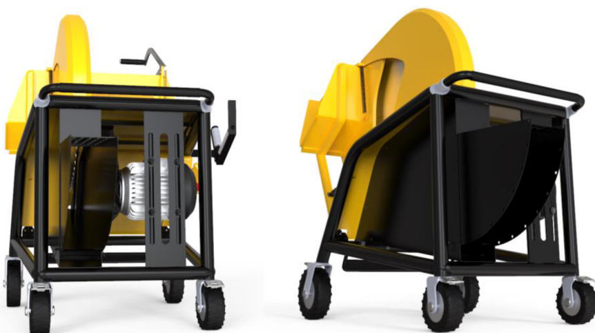
obr. 6-11 Vyklopná plocha spodního krytu
