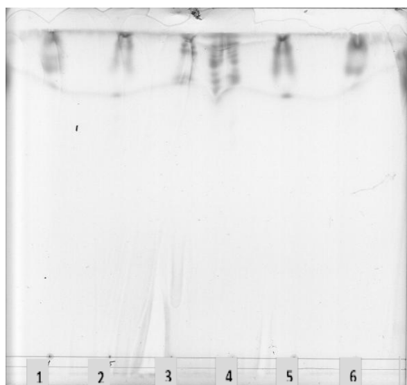
Obrázek č. 63: Separace polárních lipidů jablek: 1,2 Šampion; 3,4 Golden Delicious; 5,6 Granny Smith. Detekce roztokem 5% kyseliny sírové v methanolu.
