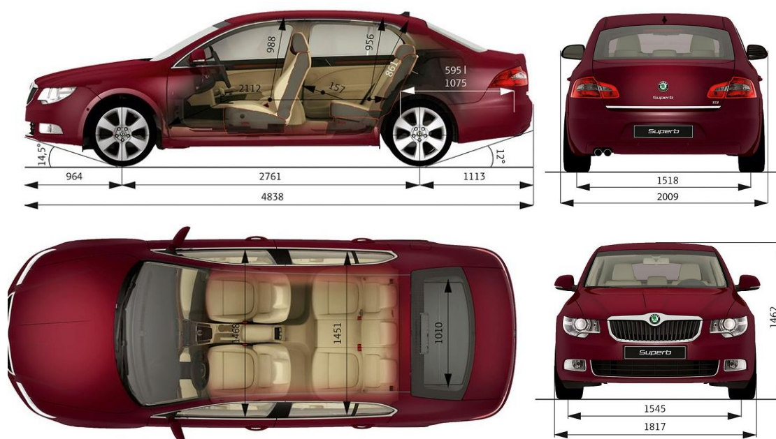
Obr. 31 Rozměry karoserie automobilu SuperbEL II.
