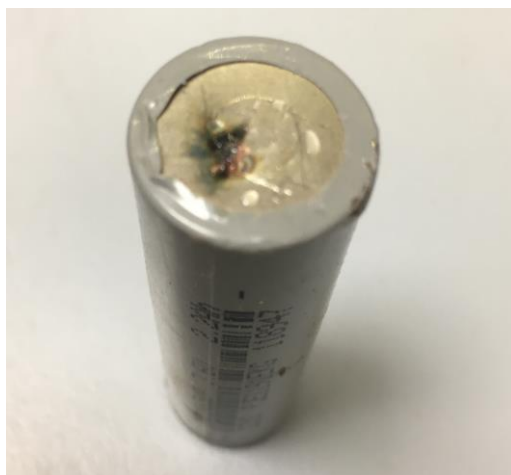
Obr. 9 Průřez bateriového článku při příliš vysoké svařovací energii.
