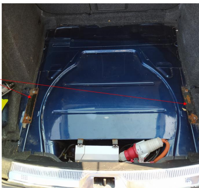
Obr. 19 Uchycení zadního bateriového boxu v kufrovém prostoru.
