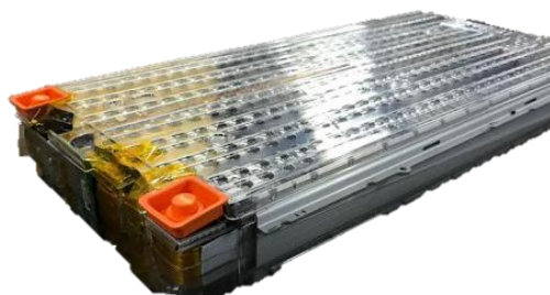
Obr. 28 Modul z modelu S 6s74p [31].
