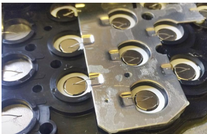
Obr. 24 Spojování článků ke sběrnici pomocí tavných pojistek [31].
