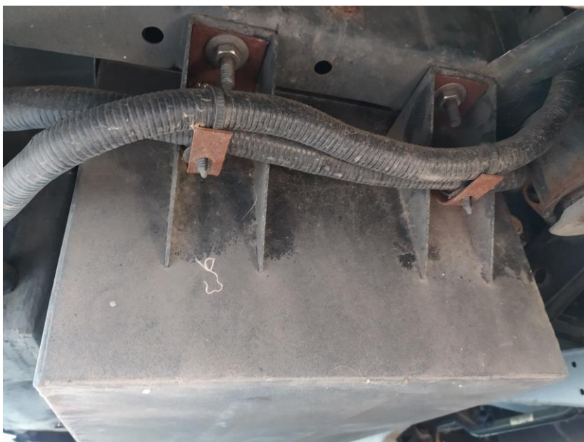
Obr. 18 Detail uchycení boxu a kabeláže za zadní nápravou.
