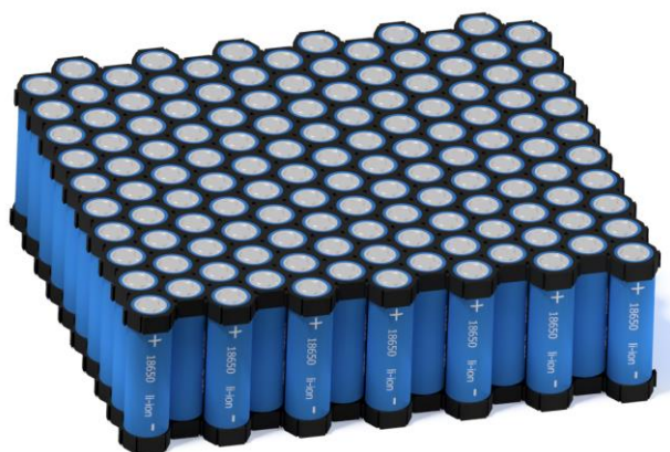
Obr. 41 3D model paralelního modulu 1s130p.
