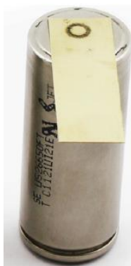
Obr. 13 Výsledek laserového svařování keyhole metodou [21].
