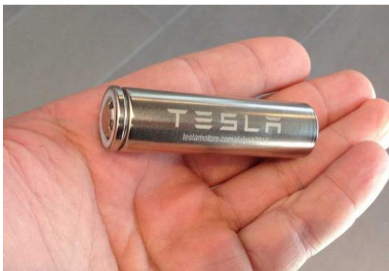
Obr. 22 Bateriový článek Panasonic 18650 od Tesla motors inc.
