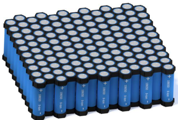
Obr. 41 3D model paralelního modulu 1s130p.
