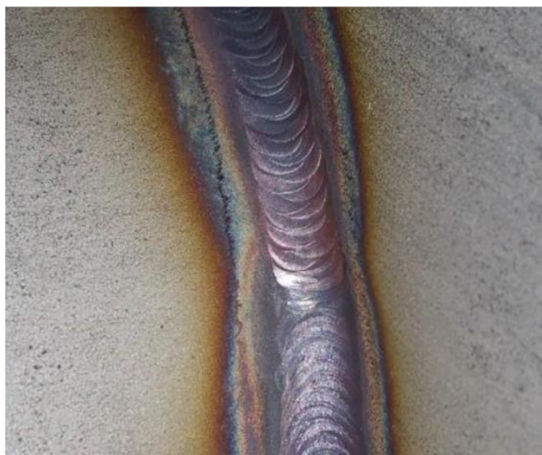
Obr. 56 Svar metodou TIG na materiálu 1.4301.
