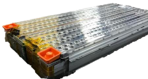
Obr. 28 Modul z modelu S 6s74p [31].
