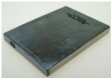
Obr. 4 Prismatický lithium-iontový článek [14].
