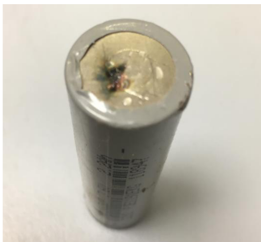
Obr. 9 Průřez bateriového článku při příliš vysoké svařovací energii.
