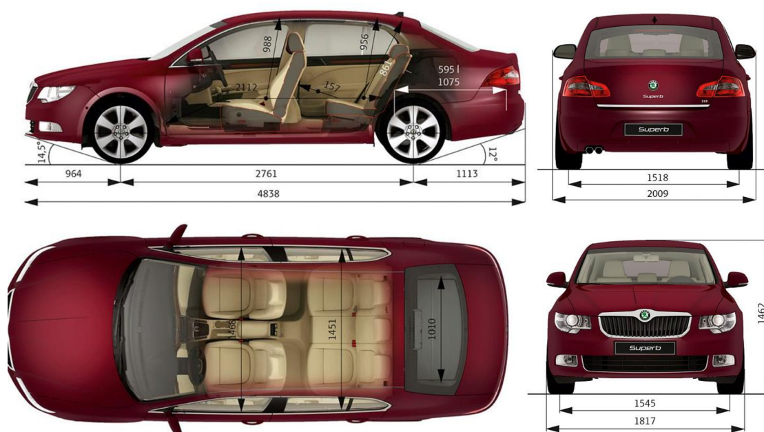
Obr. 31 Rozměry karoserie automobilu SuperbEL II.
