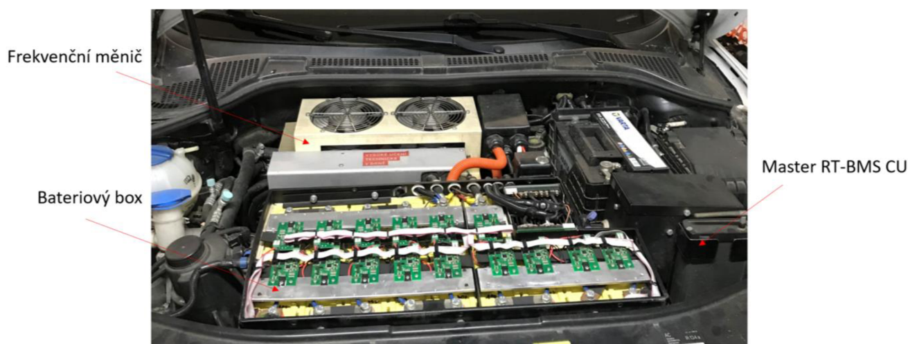
Obr. 15 Pohled do motorového prostoru elektromobilu SuperbEL II.
