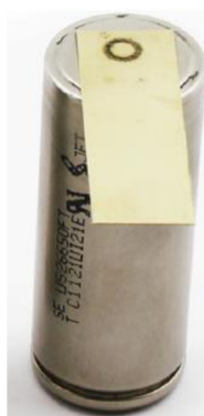
Obr. 13 Výsledek laserového svařování keyhole metodou [21].
