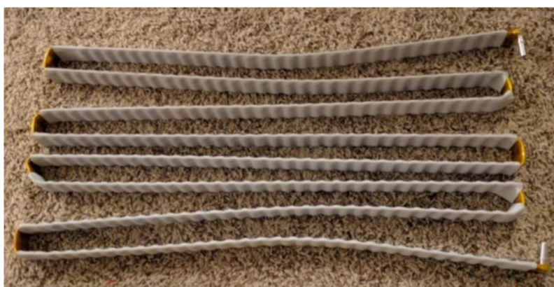
Obr. 25 Chladicí potrubí z BTM Tesla model S [31].
