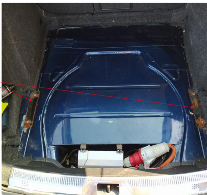
Obr. 19 Uchycení zadního bateriového boxu v kufrovém prostoru.
