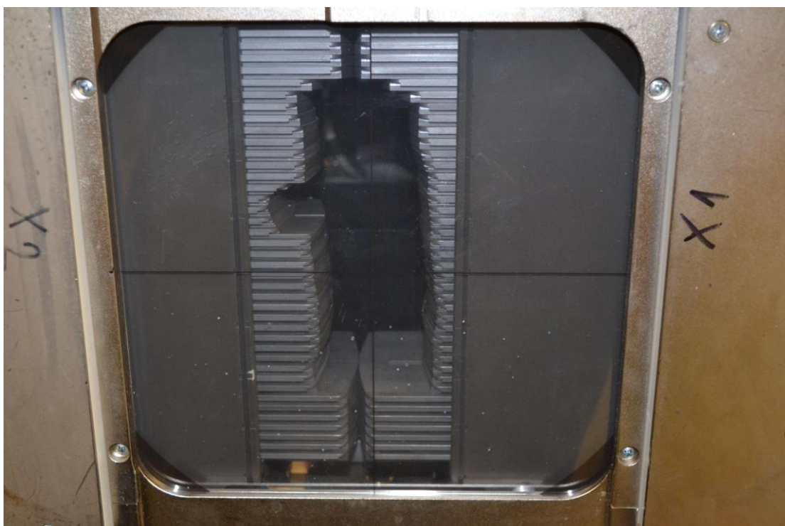
Obr. č. 6 Ukázka vícelamelového kolimátoru
