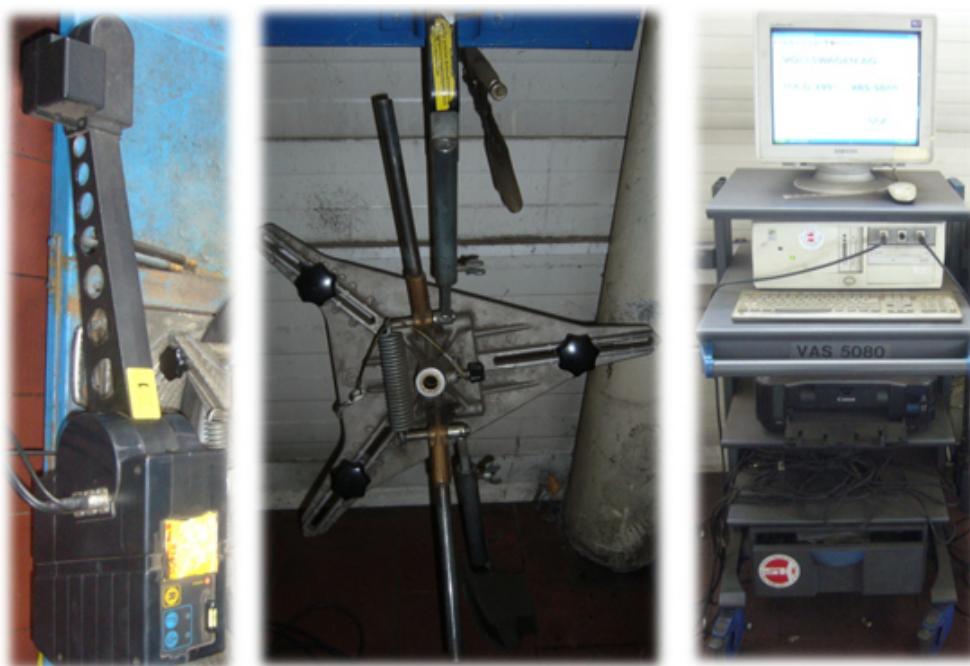
Obr. 4.13: Součásti zařízení Beißbarth VAG 1995 K/VAS 5080 pro měření geometrických parametrů zavěšení – měřicí hlavice (vlevo), upínací držák hlavice (uprostřed), řídicí počítač (vpravo)
