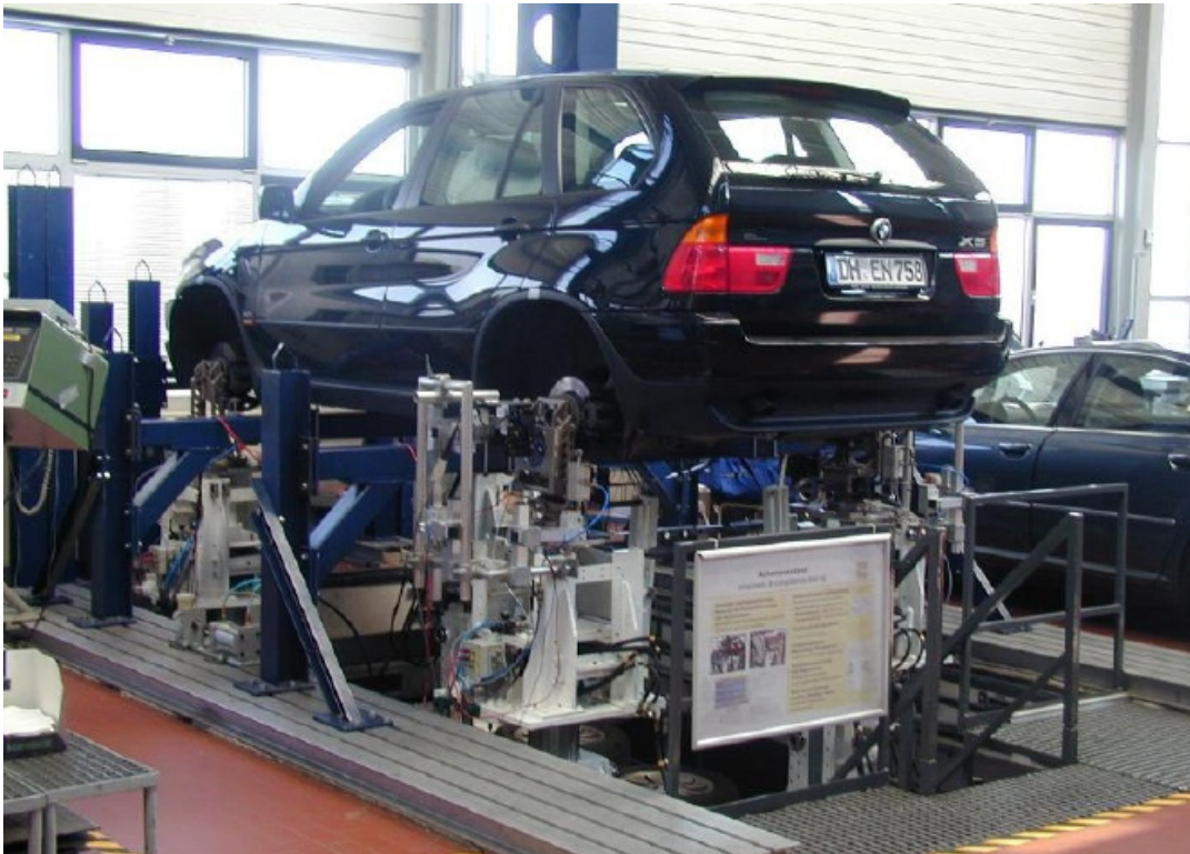
Obr. 2.9: Ukázka zkušebního stavu pro měření elastokinematiky celého vozu [60]
