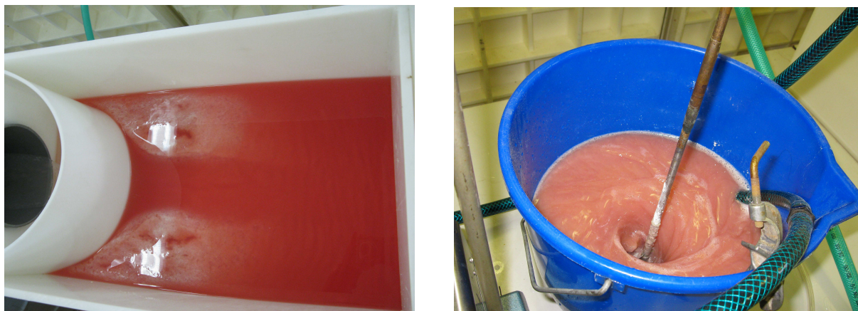
Obr. 4.9 – OLK se směsí znečištění a míchání směsi peristaltickým čerpadlem
