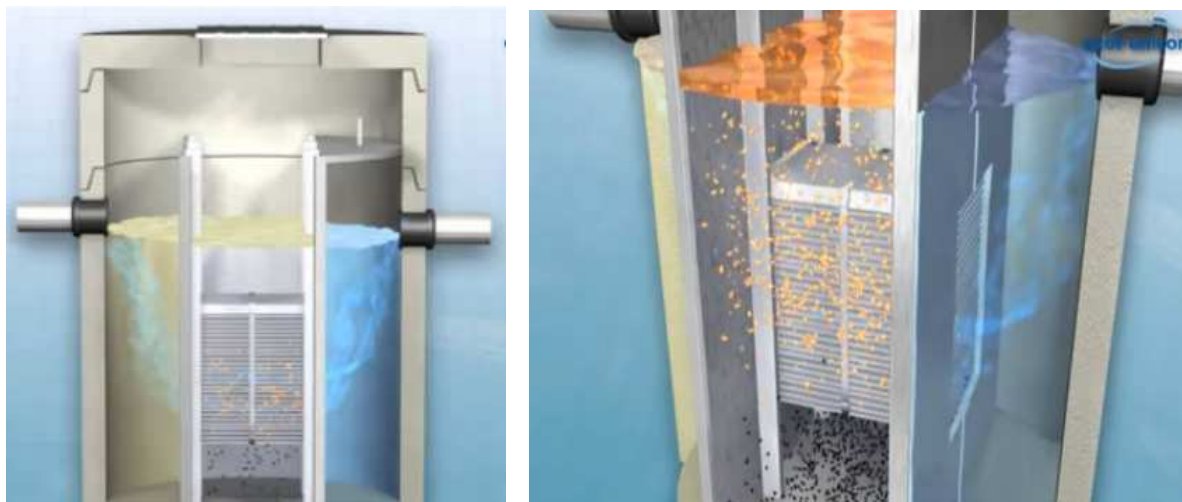
Obr. 2.18 – Řez lamelovým odlučovačem lehkých kapalin (Ecol-Unicom, 2009)
