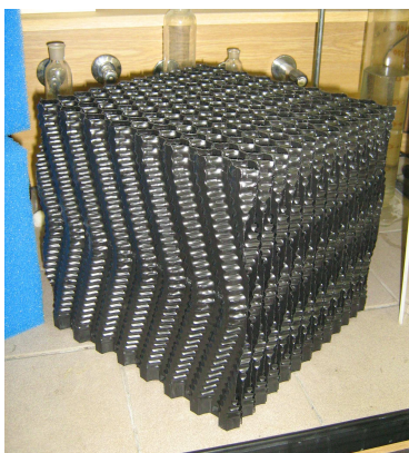
Obr. 4.5 – Voštiny (prostorová několikrát zalomená trubice, typ 2H)
