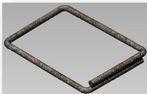
Obr. 22 Základní typy ocelových třmíneků a 3D model třmínku
