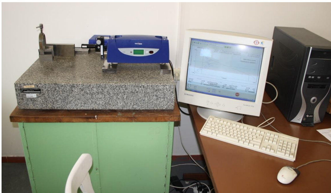
Obr. 4.8 Měřicí aparatura Form Talysurf Intra 50.
