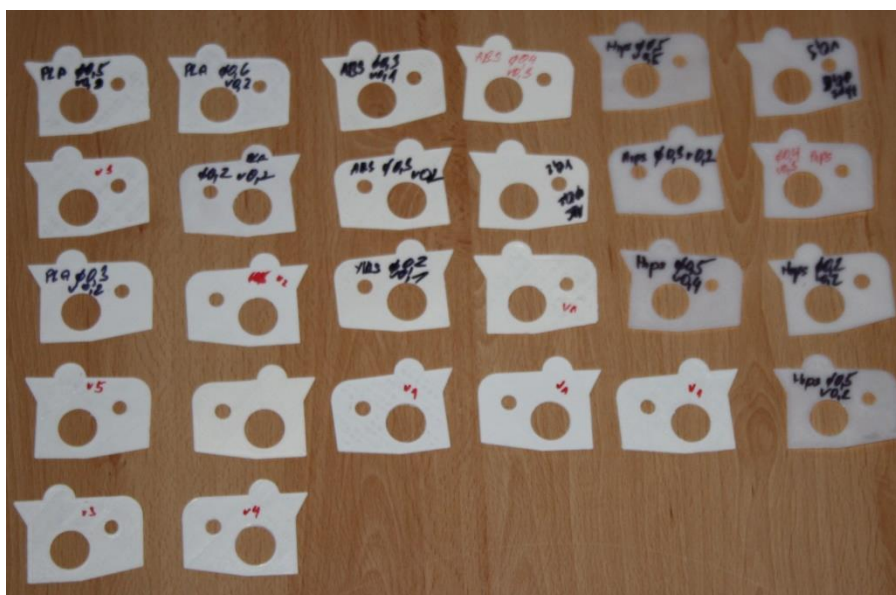
Obr. 4.11 Část vzorků vyrobených pro ověření tvarové přesnosti.
