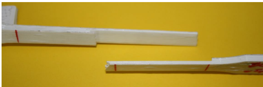
Obr. 5.4 Vzorek 7 po provedení tahové zkoušky.
