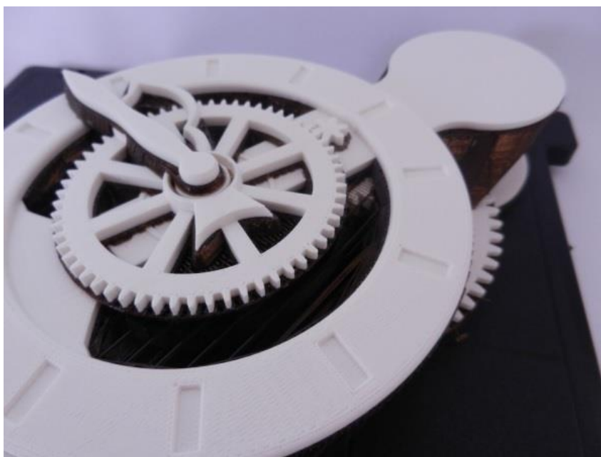
Obr. 1.6 Ukázka vyrobeného modelu hodin (s neodstraněným podpůrným materiálem) umístěného na modelovací podložce [9].
