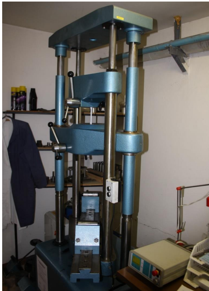
Obr. 4.3 Zkušební stroj ZD40 pro provedení tahové zkoušky
