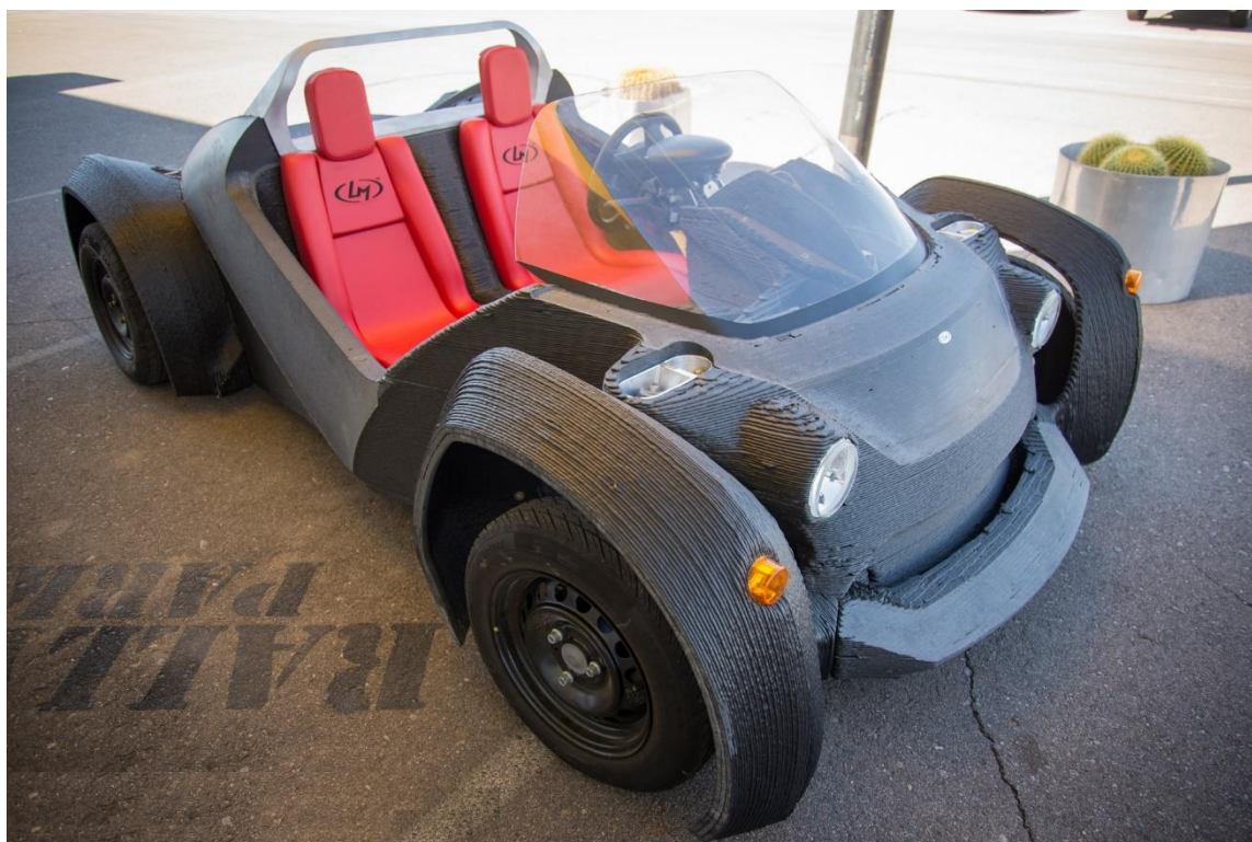
Obr. 1.1 Vytištěný skelet automobilu Local Motors Strati [3].
