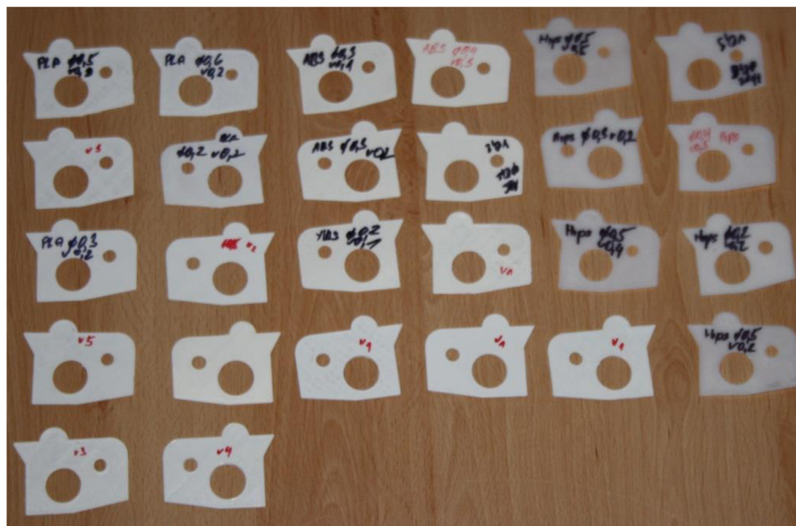
Obr. 4.11 Část vzorků vyrobených pro ověření tvarové přesnosti.
