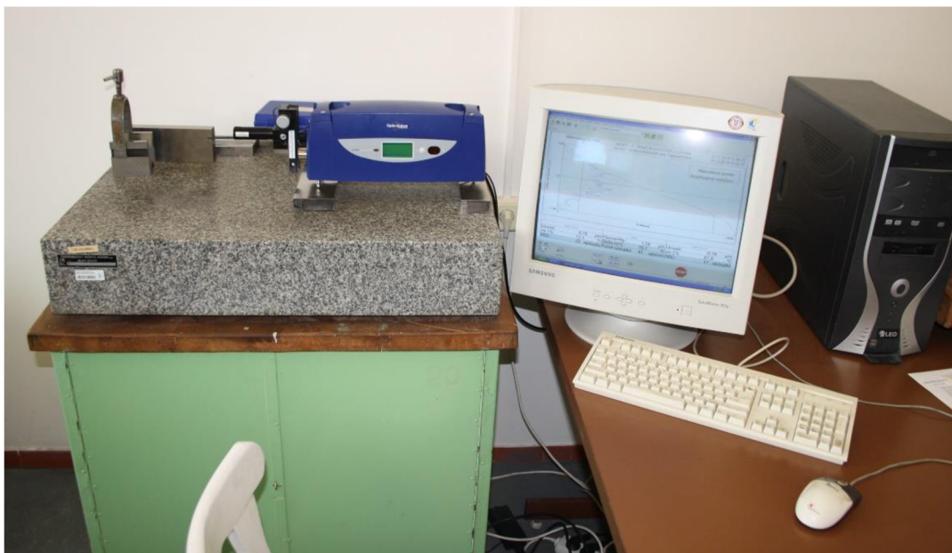
Obr. 4.8 Měřicí aparatura Form Talysurf Intra 50.
