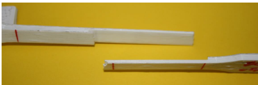
Obr. 5.4 Vzorek 7 po provedení tahové zkoušky.
