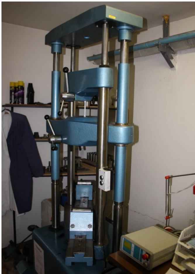
Obr. 4.3 Zkušební stroj ZD40 pro provedení tahové zkoušky
