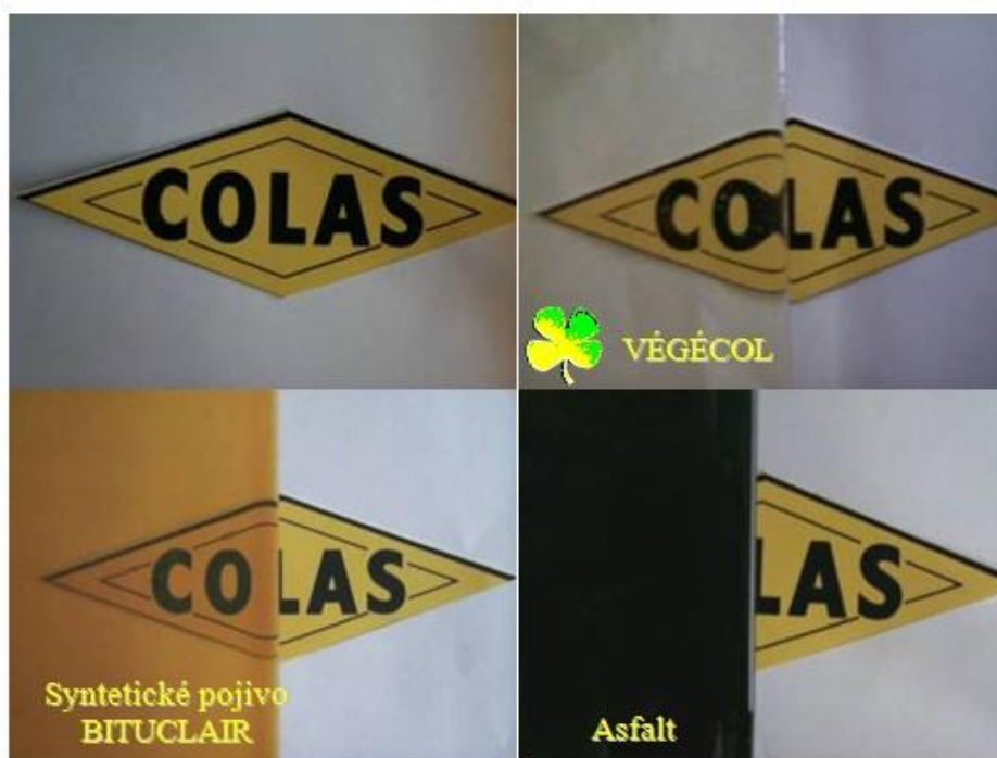
Obrázek 6-2: Srovnání průhlednosti a barvy netradičních pojiv firmy COLAS [37]
