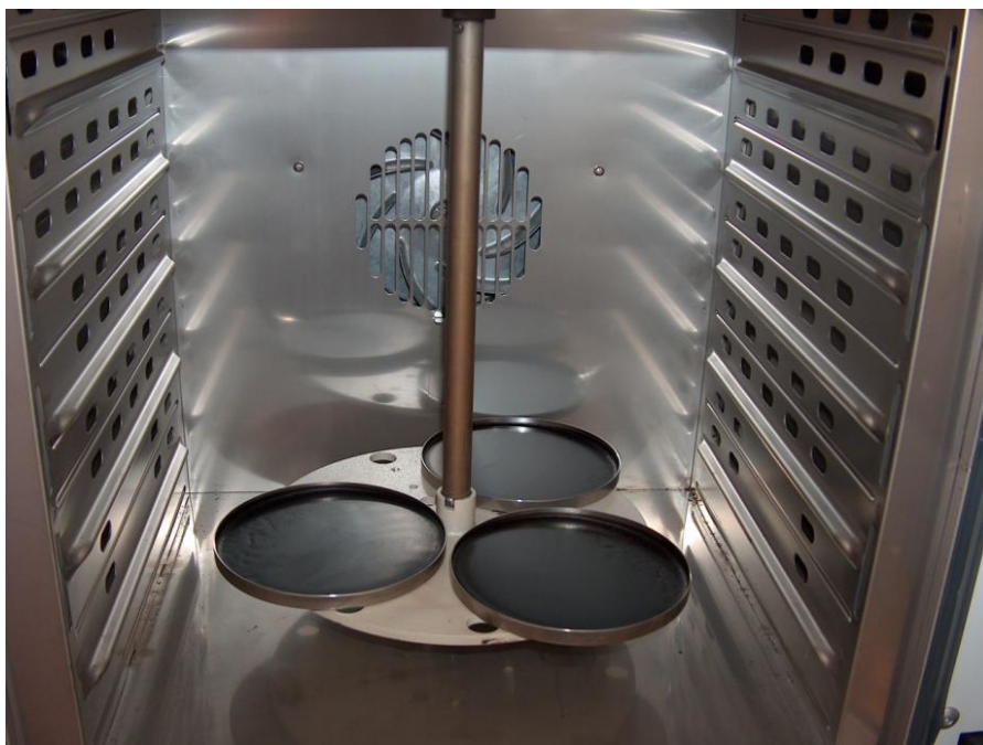
Obrázek 5-12: Vzorky pojiva v sušárně připravená ke zkoušce TFOT [32]
