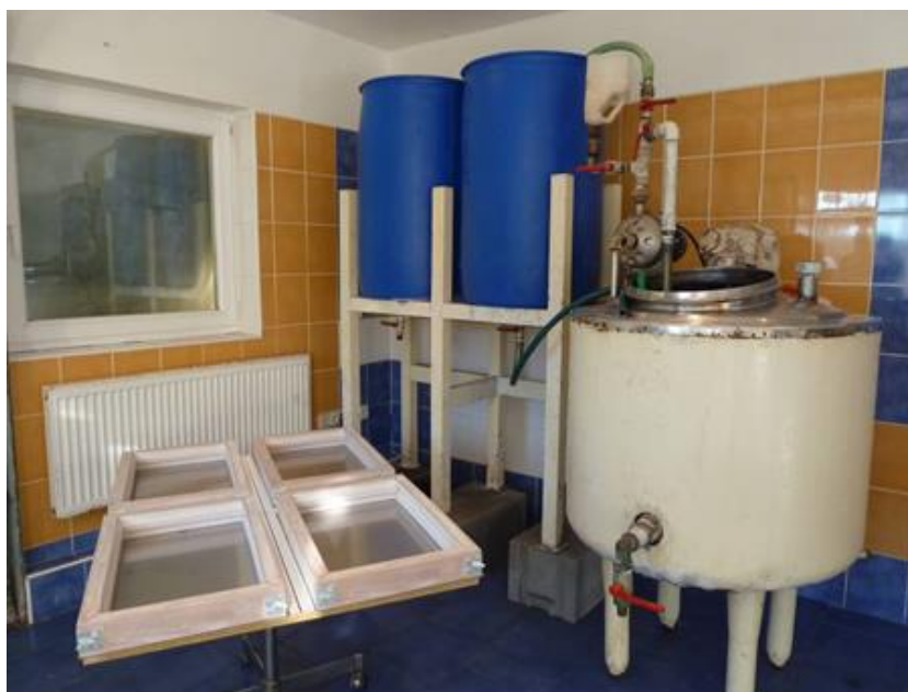
Obr. 51: Poloprovozní aparatura přípravy sádrové tvarovky
