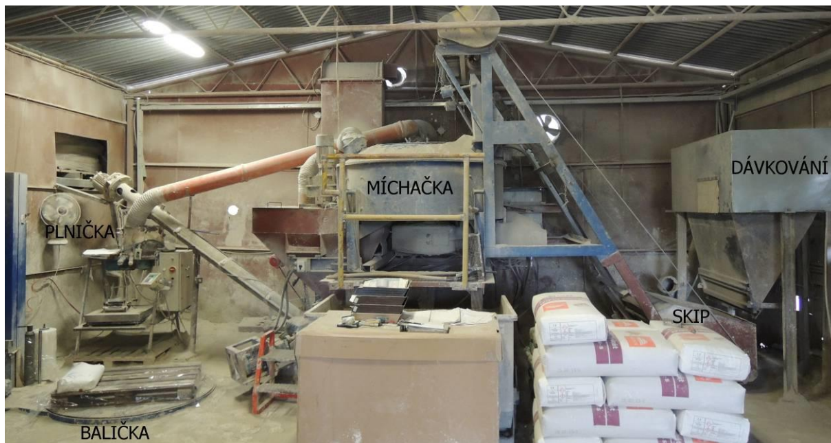
Obr. 47: Technologická linka přípravy suchých maltových směsí
