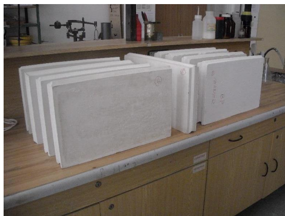
Obr. 50: : Ukázka poloprovozní formy (vlevo) a výsledného produktu (vpravo)
