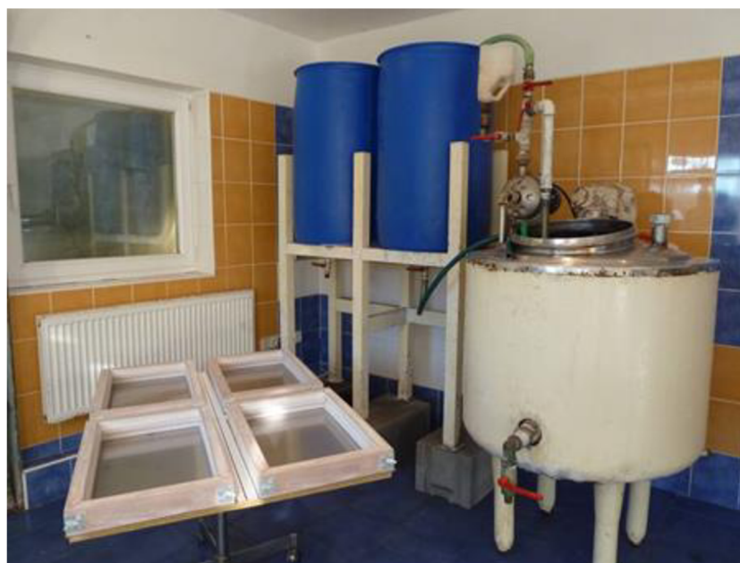
Obr. 51: Poloprovozní aparatura přípravy sádrové tvarovky
