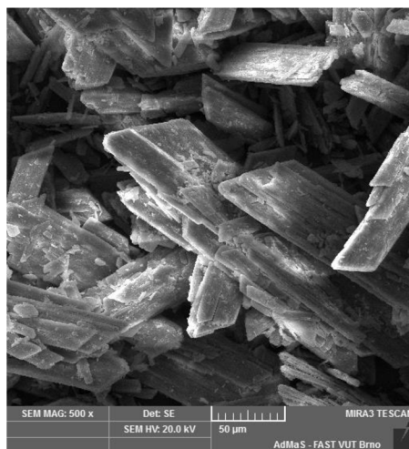
Obr. 29: Rozlístkovávaná struktura zm laboratorně vyrobené beta sádry z druhotných suroviny (500 x)
