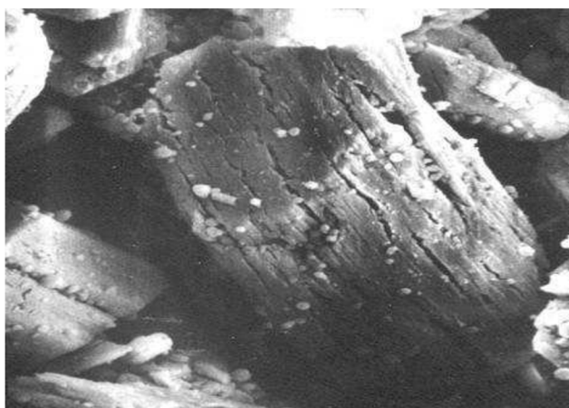
Obr. 12: \beta -sádra ve formě silně rozlískované pseudomorfózy po sádrovci (zvětšení 4000x)
