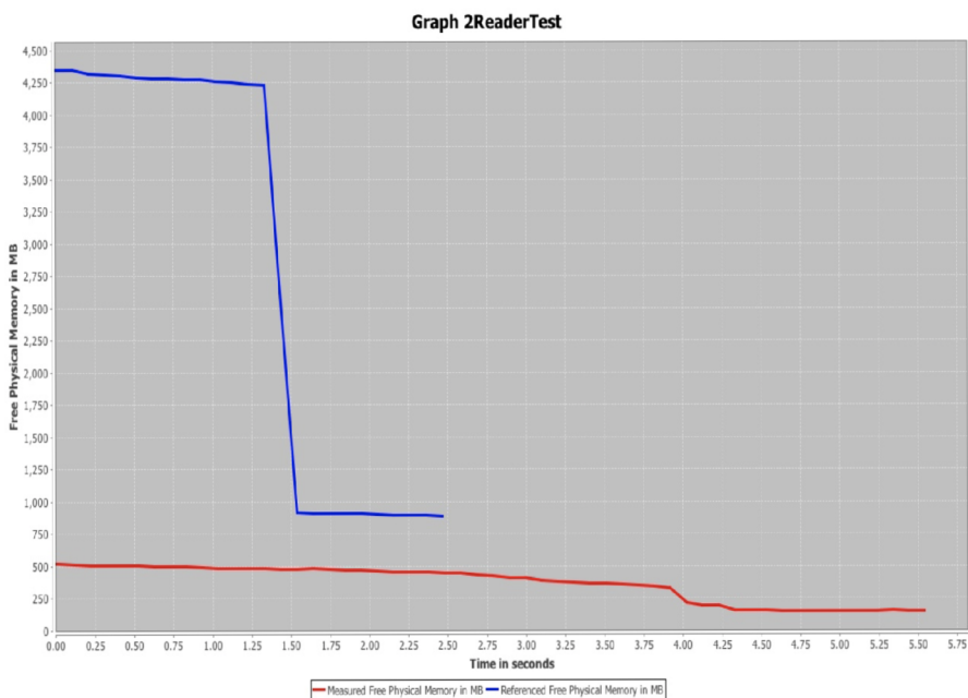
Obr. D.8: HTML report reprezentujúci test ETL Grafu. Graf porovnávajúci veľkosť voľnej fyzickej pamäte nameraných a referenčných dát.
