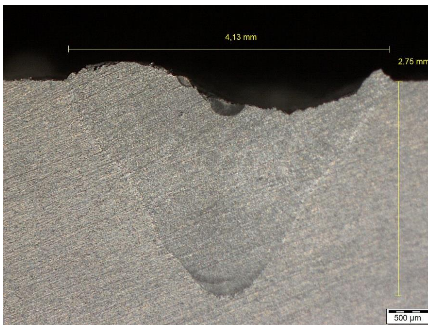
Obr. 53 Příčný řez vzorkem č.5 (laser-TIG -40A).
