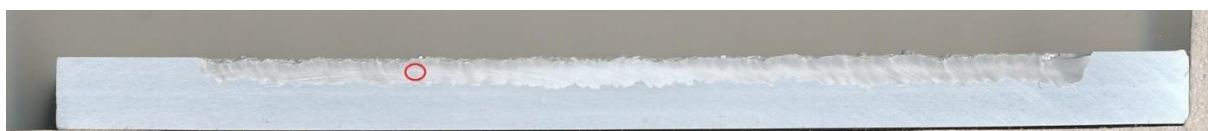
Obr. 48 Zkušební vzorek č.7 (Laser-TIG +20A).
