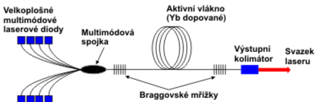
Obr. 5 Princip vláknového laseru. [29]
