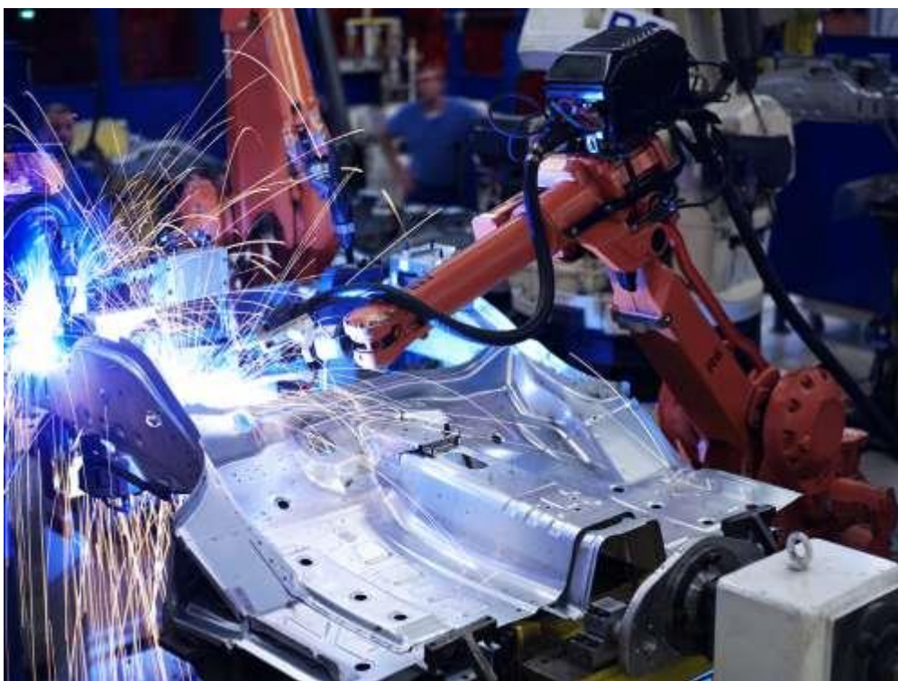
Obr. 1 Laserové svařování karosérie na montážní lince Fiat Fiorino. [1]
