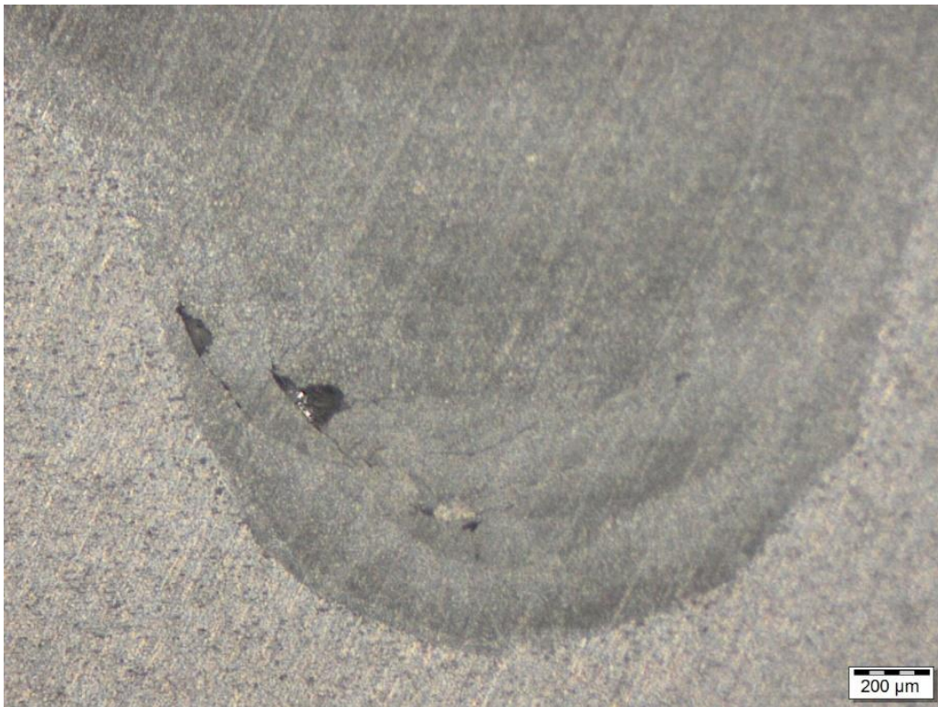
Obr. 41 Detail na horké trhliny u vzorku č.1.
