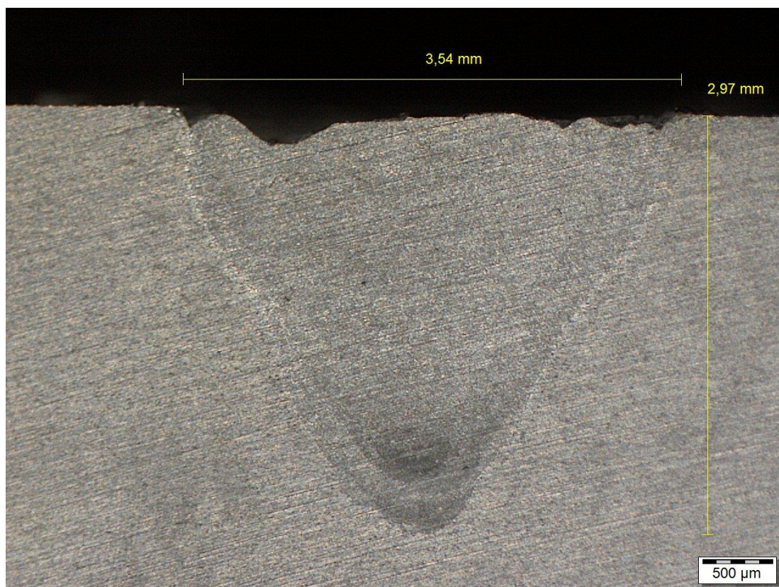
Svar zkušebního vzorku č.9 (Laser-TIG +40A)
