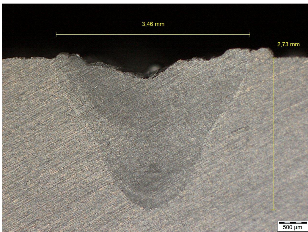
Svar zkušebního vzorku č.4 (Laser-TIG -30A)
