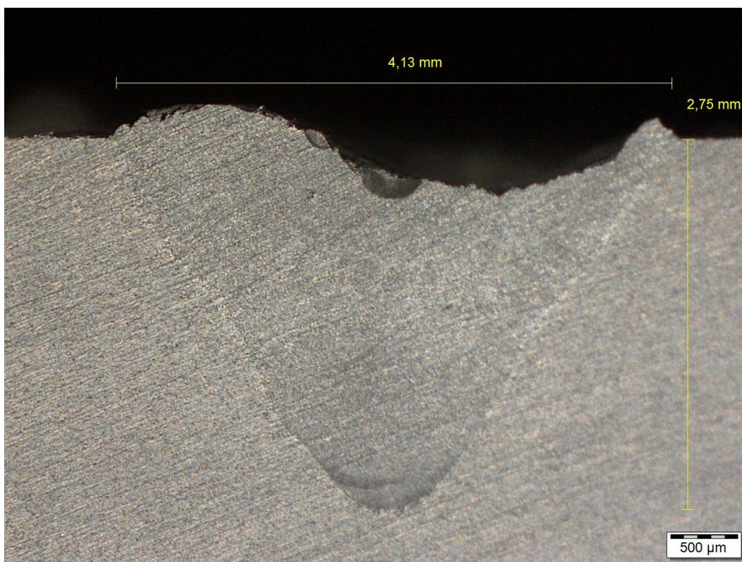
Svar zkušebního vzorku č.5 (Laser-TIG -40A)
