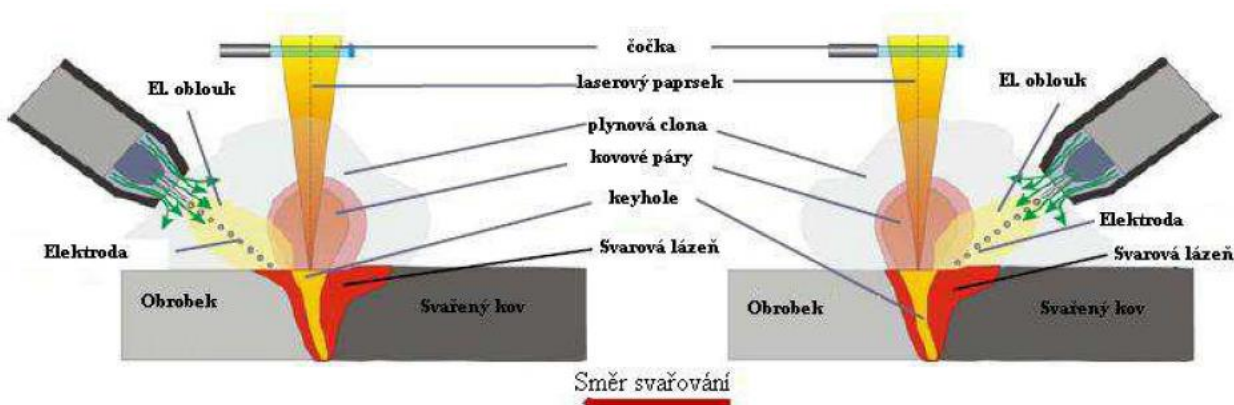
. Obr. 22 Uspořádání soustavy Laser-TIG. [17]
