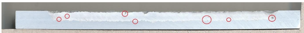
Obr. 46 Zkušební vzorek č.5 (Laser-TIG -40A).
