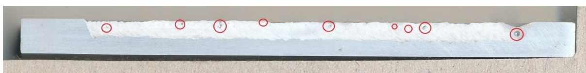
Obr. 52 Zkušební vzorek č.11 (Laser-TIG střídavý 50A, 500Hz).
