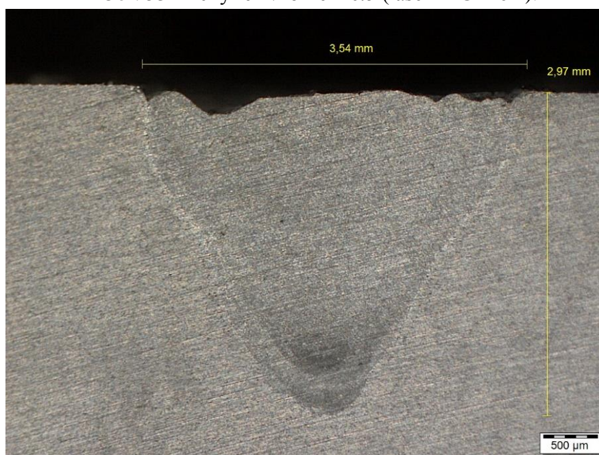
Obr. 54 Příčný řez vzorkem č.9 (laser-TIG +40A).
