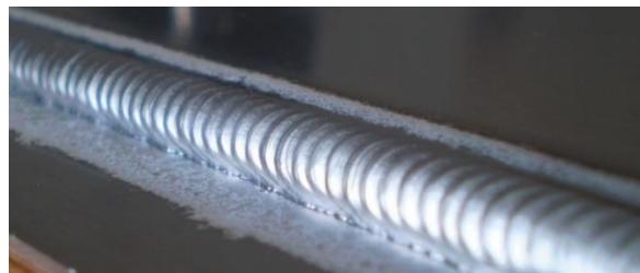
Obr. 21 Ukázka penízkového svaru. [33]
