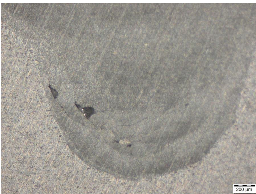
Obr. 41 Detail na horké trhliny u vzorku č.1.
