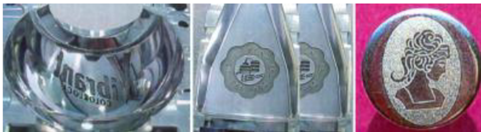
Obr. 12 Příklady gravírovaných součástí. [21]
