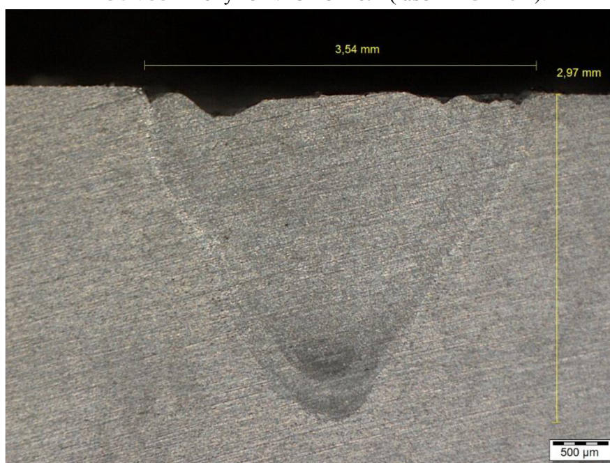
Obr. 54 Příčný řez vzorkem č.9 (laser-TIG +40A).
