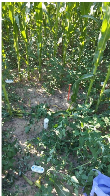
Obr. 52 Rozložení půdních teploměrů a vlhkoměru půdy v terénu; výzkumný pod „kukuřice“; (vlastní fotografie, 2. 9. 2023)
