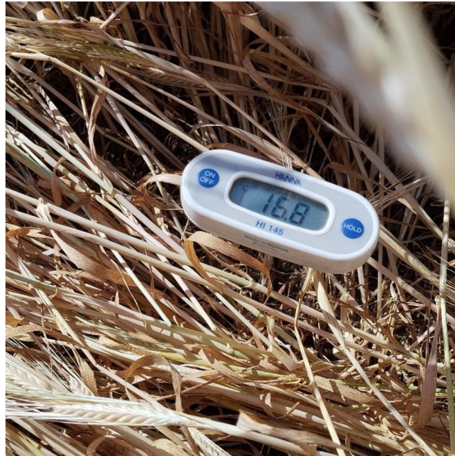
Obr. 12 Ukázka umístění půdního teploměru v porostu polní plodiny (ječmen obecný) (zdroj: vlastní fotografie, 8. 7. 2023)
