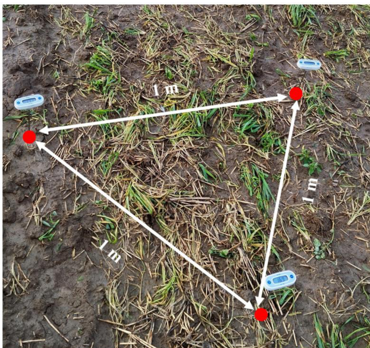
Obr. 11 Rozmístění půdních teploměrů v terénu (zdroj: vlastní fotografie)
