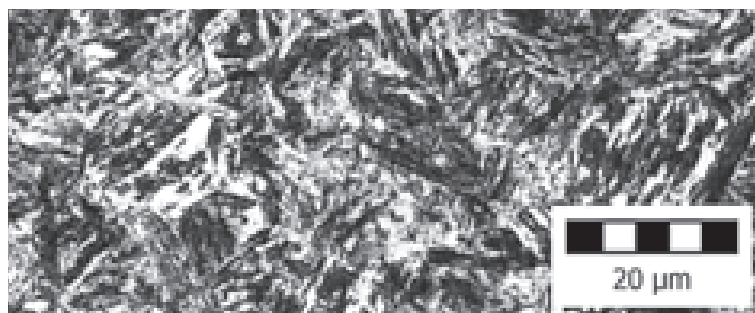
Obrázek D.1: Dláto – Podeutektoidní ocel, struktura odpovídá popuštěnému mantenzitu, se zbytkovým austenitem; (100x zvětšeno; leptáno – Nital (4 %)).
