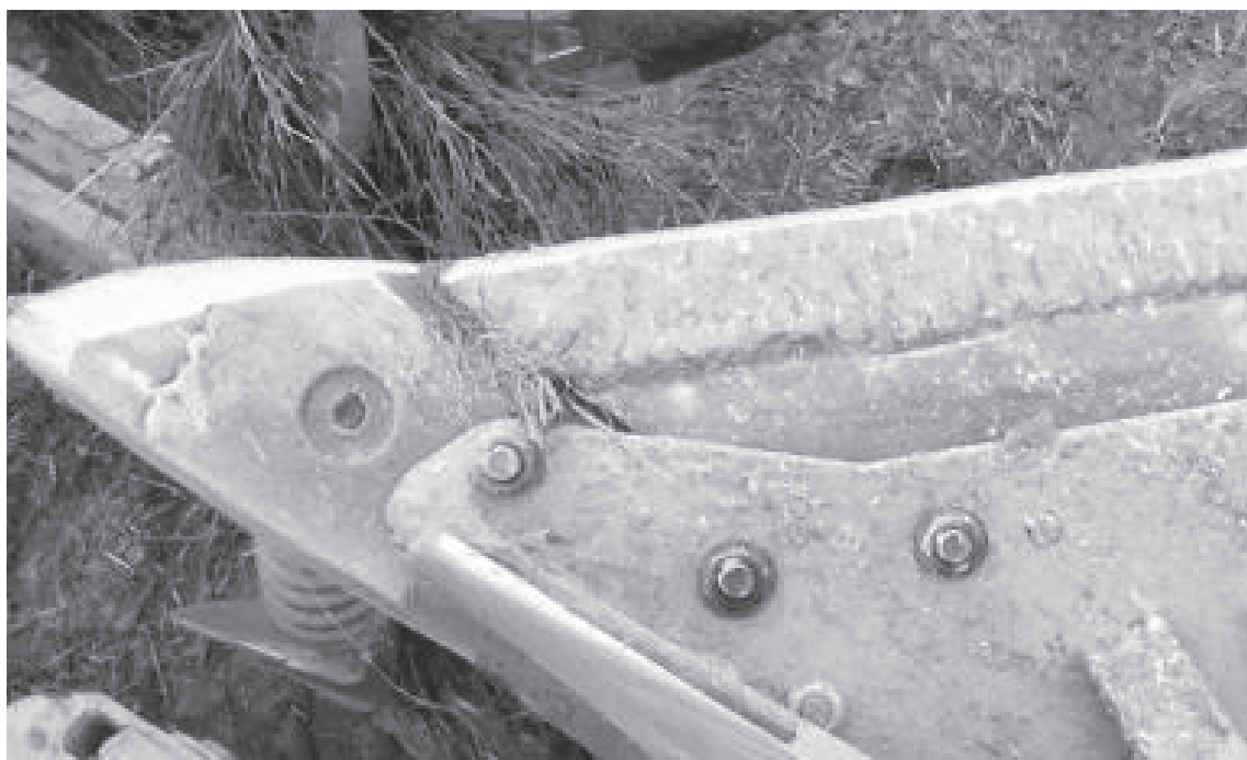
Obrázek K.6: Průběžná kontrola opotřebení ploch opatřených návary.
