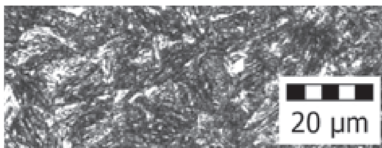
Obrázek D.2: Ostří – Podeutektoidní ocel, struktura odpovídá popuštěnému mantenzitu, se zbytkovým austenitem; (100x zvětšeno; leptáno – Nital 4 %).
