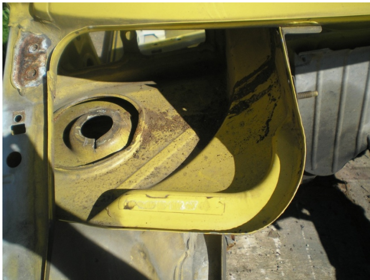
Obrázek č. 34 - Umístění VIN kódu u pravého horního uložení tlumiče pérování
