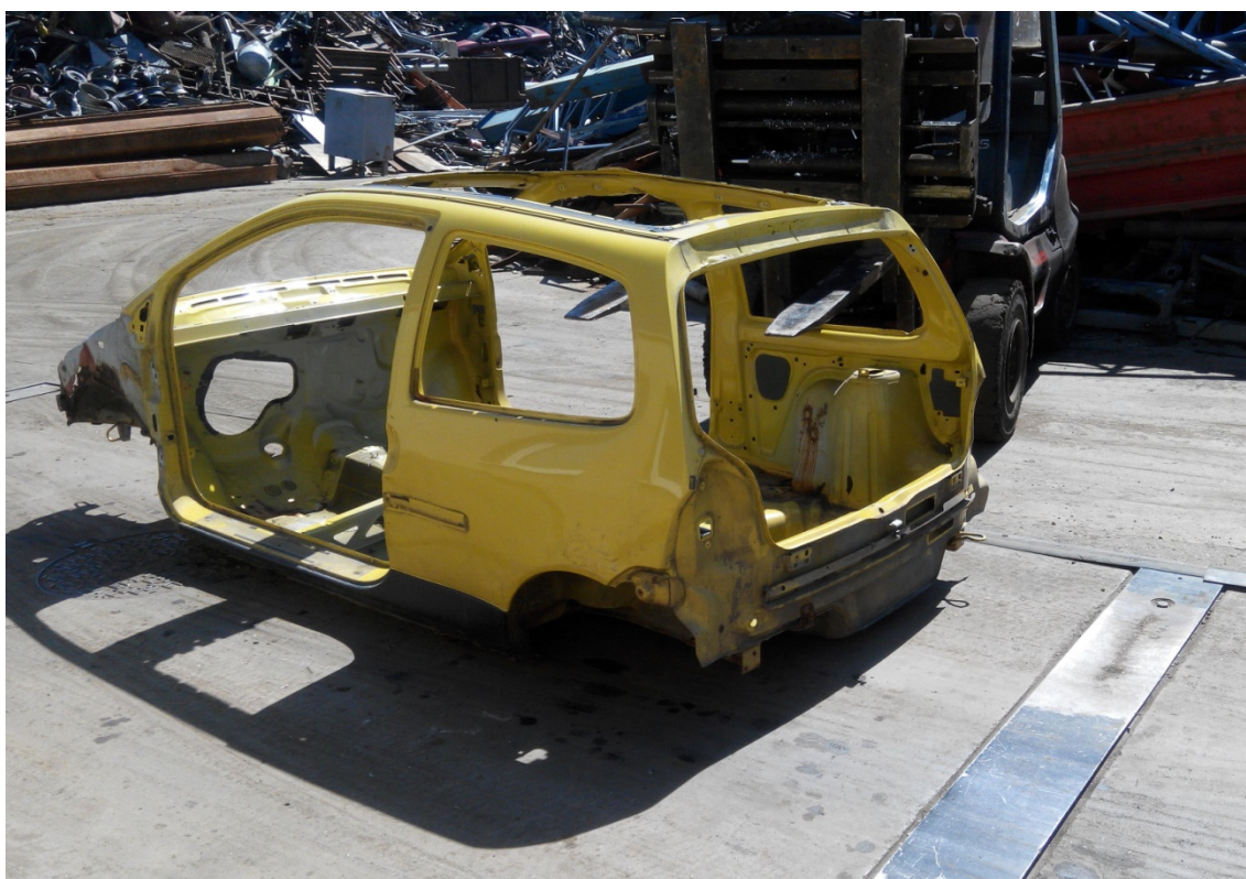
Obrázek č. 41 - Odstrojený skelet karoserie ve sběrně autovraků
