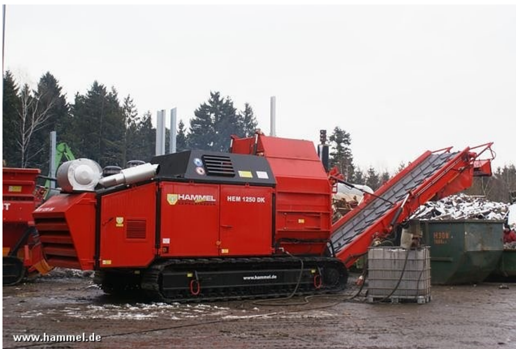
Obrázek č. 10 - Drtič karoserií a kovového odpadu,
