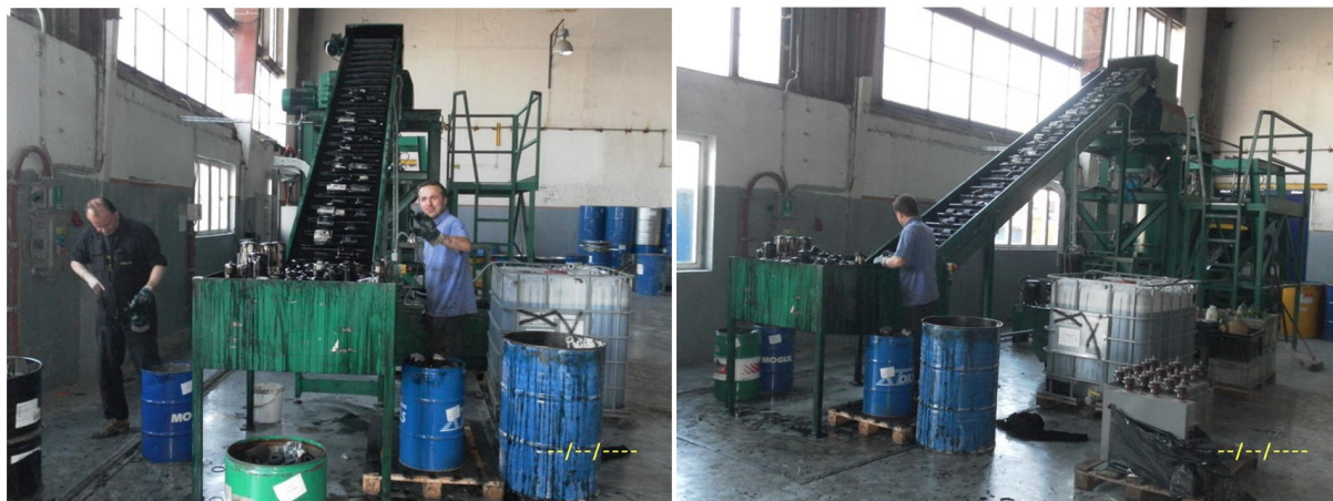
Obrázek č. 27 - Linka pro likvidaci použitých olejových filtrů, zdroj:
