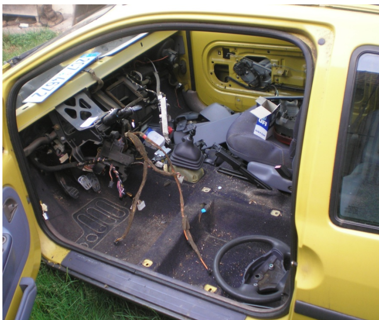
Obrázek č. 39 - Demontáž interiéru
