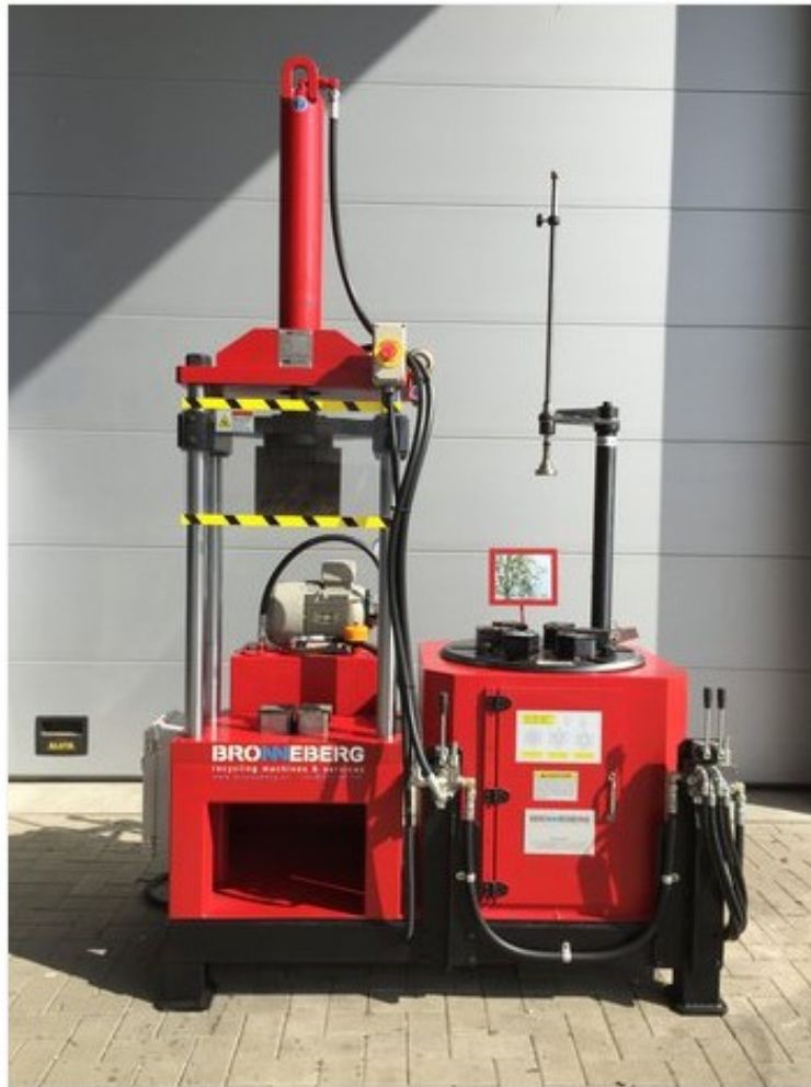
Obrázek č. 25 - Stříhač elektromotorů, zdroj: http://www.rpjr.cz/katalog/recyklacni-technika/ostatni/926037-strihac-motoru-55kw-strihac-motoru/ „staženo dne 12. 1. 2018“
