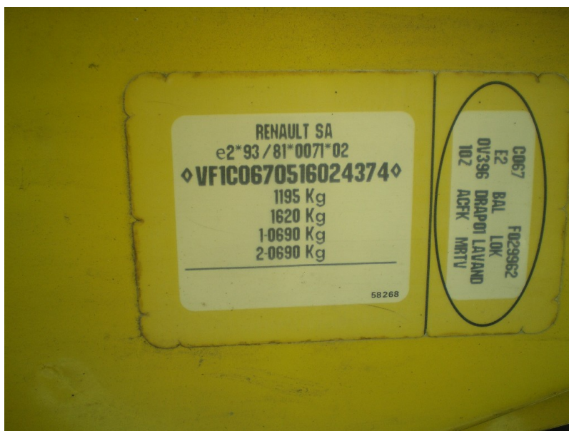
Obrázek č. 35 - Umístění výrobního štítku na pravém B sloupku karoserie
