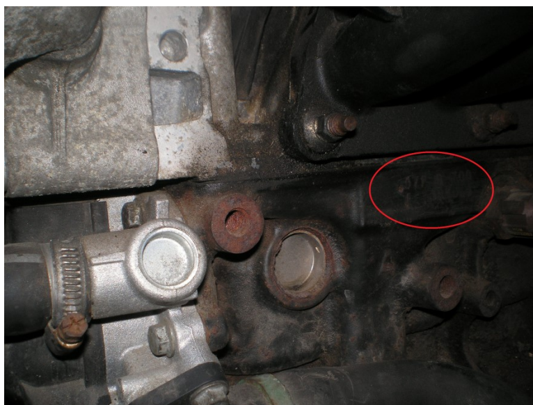
Obrázek č. 36 - Umístění kódu a výrobního čísla motoru
