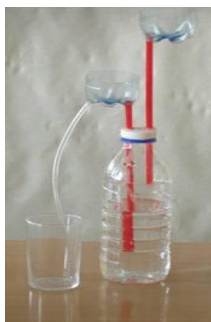
Obr. č. 32 Heronova fontána, převzato a upraveno z [22]
