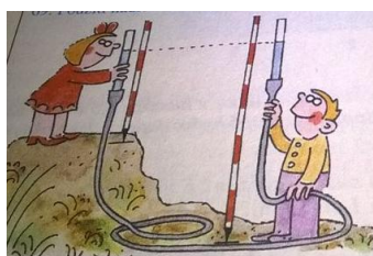
Obr. č. 10. Hadicová vodováha, převzato a upraveno z [12, str. 120]
