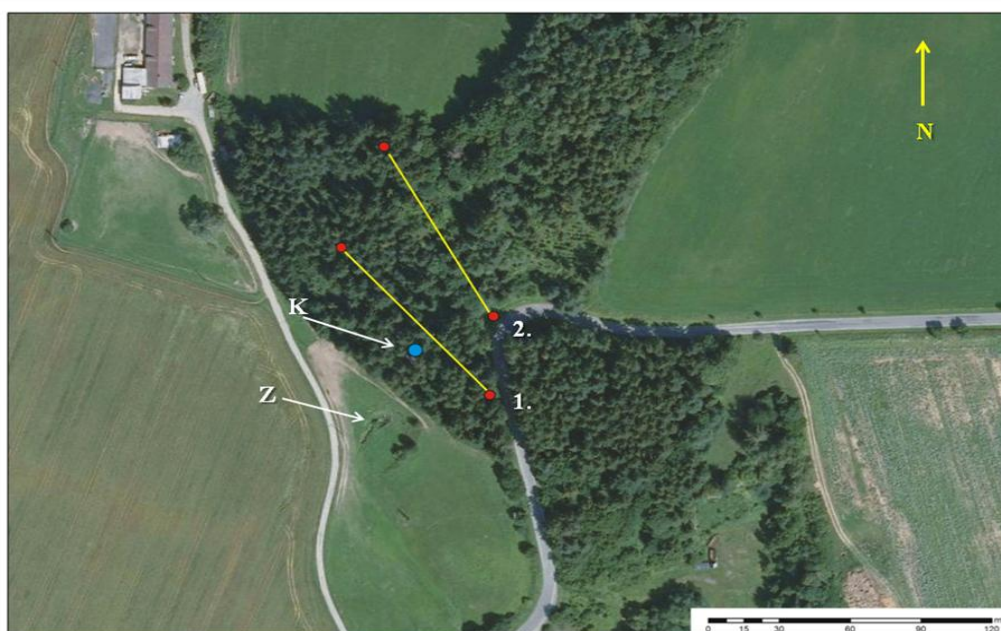
Obr.-5.10- Ortofotomapa lokality Suchý žleb převzata a upravena z Geoportalu Cenia, se znázorněnými měřeními profily, které jsou označeny číslicemi 1 a 2, Z – závrt, K –vykopaný komín.
