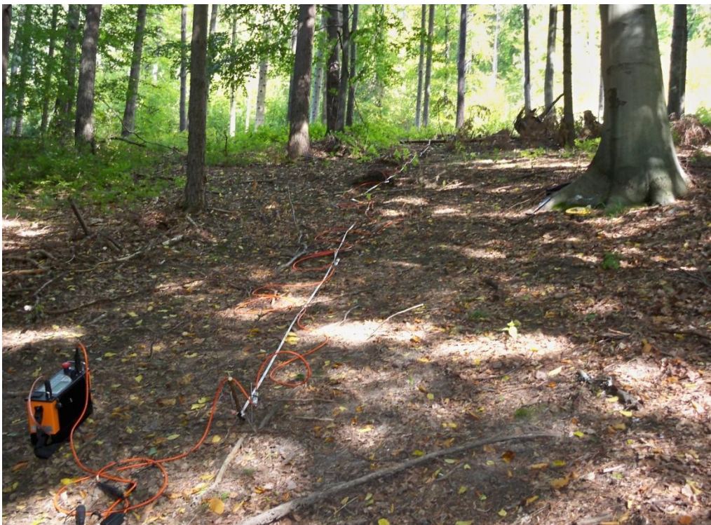
Obr.-4.2b Zapojení řídicí jednotky s aktivním multielektrodoým kabelem v lokalitě Brablenec „Za Hájovnou“.
