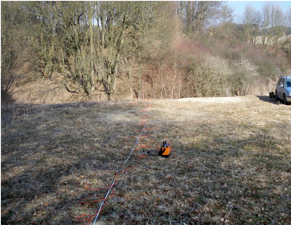
Obr.-4.2a Zapojení řídicí jednotky s aktivním multielektrodoým kabelem v lokalitě Špraněk „U Transformátoru“.
