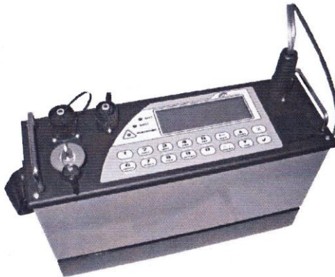
Obr.-4.1- Řídící jednotka ARES v 5.3 (Gf instruments)
