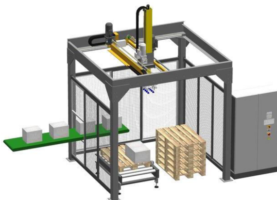
Obr. 11 Příklad paletizace s využitím manipulátoru [9]
