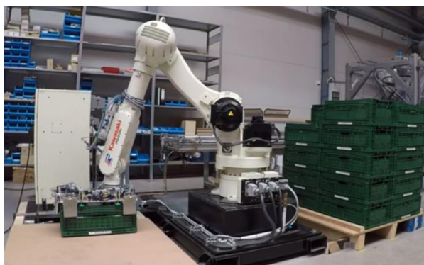
Obr. 9 Příklad nasazení PR při manipulaci s přepravkami [7]
