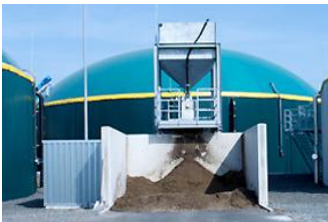
Obrázek 10 Separátor na úpravu digestátu (foto: Oekobit-biogas.com)
