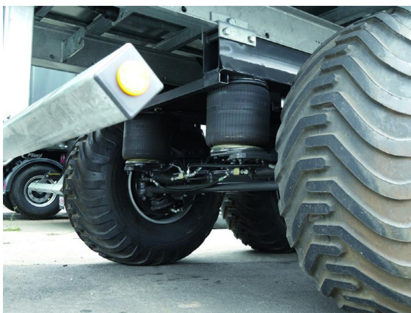
Obrázek 7. Podvozek odpružený vakovými pružinami
