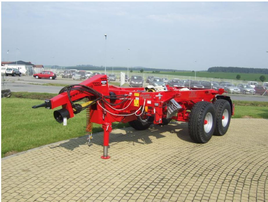
Obrázek 17. Podvozek Grand Super vybavený horní ojí, k připojení je zde tažné oko o průměru 40 mm
