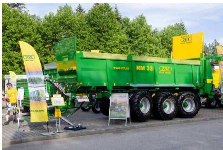
Obrázek 3. Rozmetadlo RM 33 s tridemovým podvozkiem a zvedací přední nápravou
