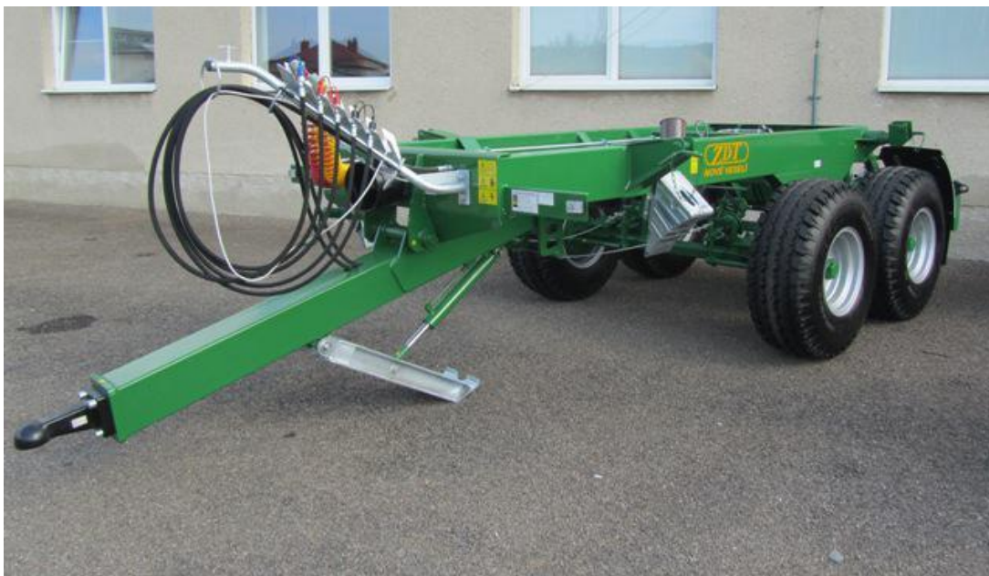
Obrázek 15. Podvozek Grand Super, vybavený spodní ojí, pneumatikami 14,5/80-18 a přípojným zařízením K80
